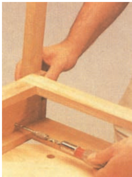
شکل ۶-۱۵۹ اتصال قاب دراور به قاب کناری
