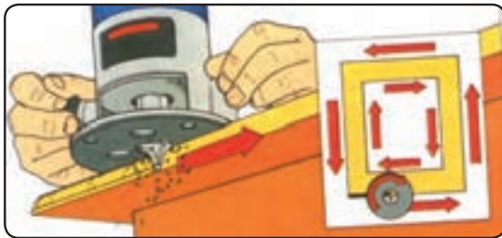
شکل ۲-۴۸ فرز زدن لبه صفحه‌کار با تیغه بدون بلبرینگ
