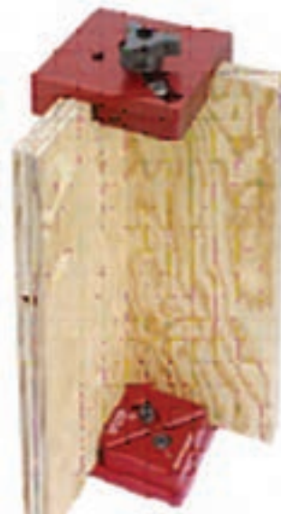
شکل ۳۶-۳ مونتاژ پانل‌های عمودی
