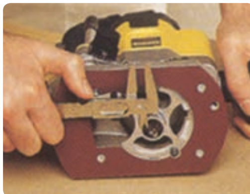
شکل ۶۸-۲ اندازه‌گیری قطر شفت فرز
