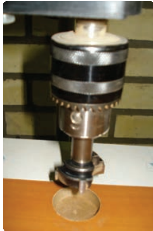
شکل ۶-۷۱ مته کابینت جهت سوراخ کردن جای لولا
