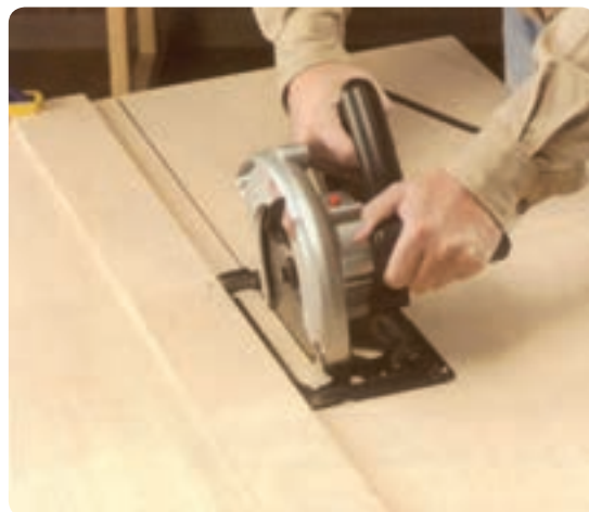
شکل ۲-۲۳ برش طولی با گونیای برراستی
