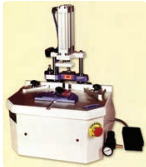
شکل ۱۰۶-۲ ماشین دم چلچلهزن نیوماتیکی
