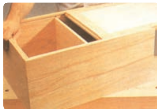
شکل ۱۴۳-۶ قرارگیری پشت بند در کنشکاف بدنه کابینت
