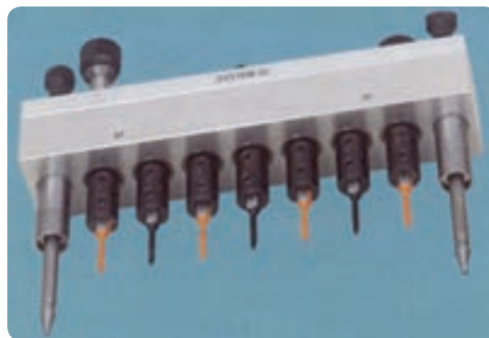
شکل ۱۲۷-۲ مجموعه متبه‌ها جهت سوراخ‌کاری عمودی
