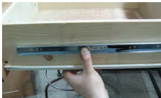
شکل ۷-۳۵ تعیین محل ریل بر روی بدنه کشو
