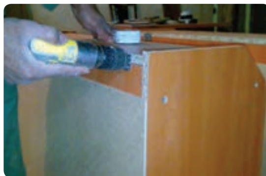
شکل ۱۳۱-۶ نصب لولای محفظه جاواکسی
