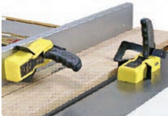
شکل ۳-۱۷ گیره‌های مغناطیسی جهت جلوگیری از پس زدن قطعه کار
