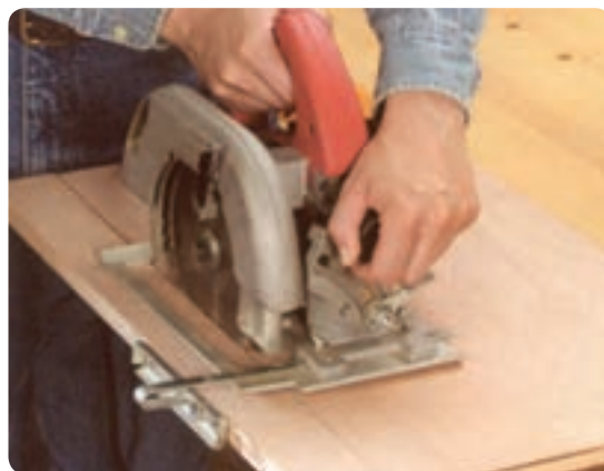
شکل ۲-۲۲ برش عرضی با گونیای ماشین
