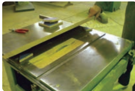
شکل ۳-۳۹ قراردادن دو عدد زیرسری برای ساخت گونیا
