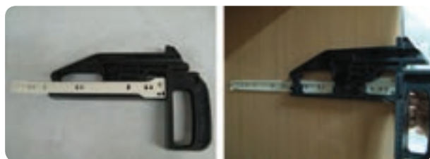
شکل ۲۷-۷ گونبای مخصوص نصب ریل
