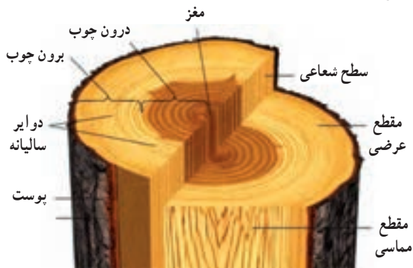
شکل ۵-۱ مقطع عرضی، مماسی، شعاعی و دایر سالیانه
