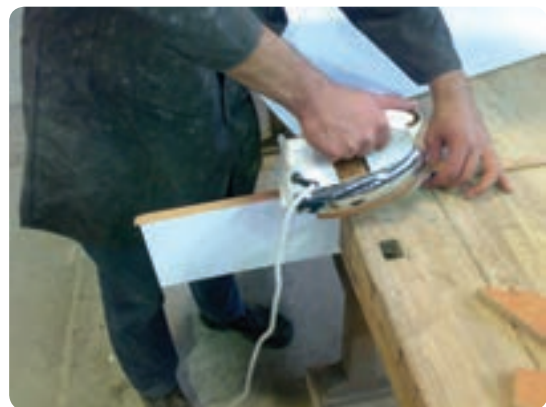
شکل ۱۴۷-۲ اتوکشی نوار روکش لبه چسبان
