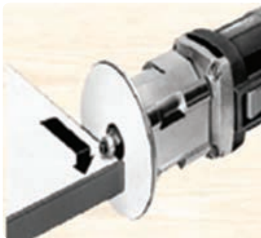
شکل ۱۵۵-۲ پرداخت لبه‌های اضافی روکش مصنوعی
