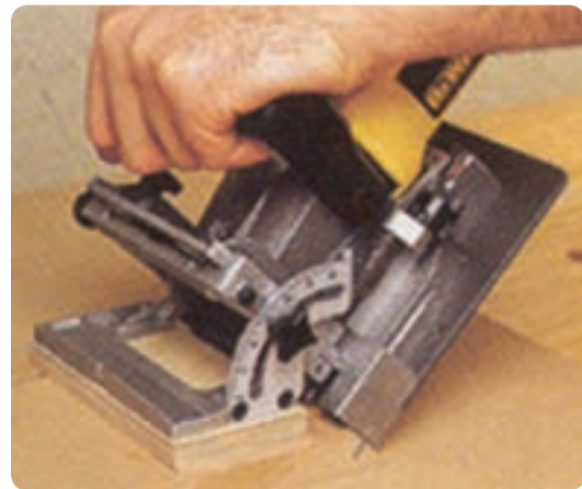
شکل ۲-۹۰ شیارزنی با زاویه ۴۵ درجه
