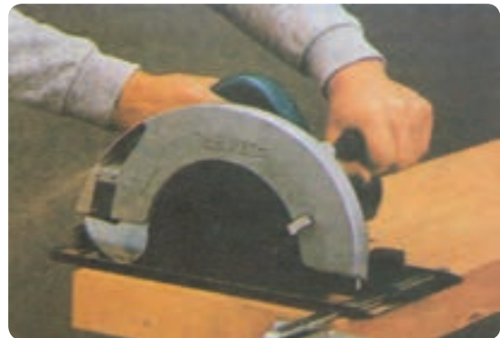
شکل ۳۶-۲ برش به وسیله گونیای دستگاه
