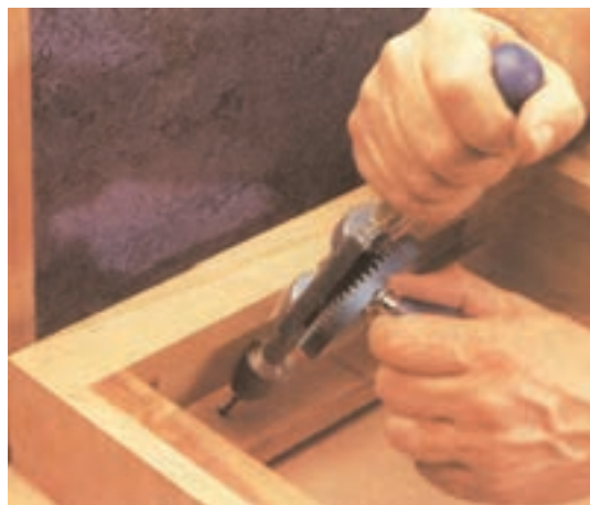
شکل ۶-۱۶۱ مونتاز صفحه میز به قاب دراور
