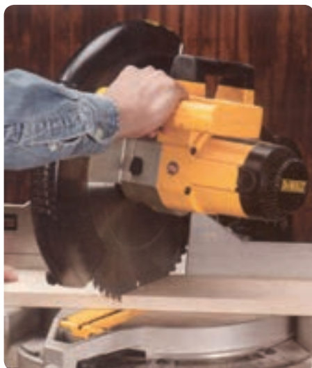
شکل ۲-۵ حرکت اهرمی در اره گرد فارسی بر
