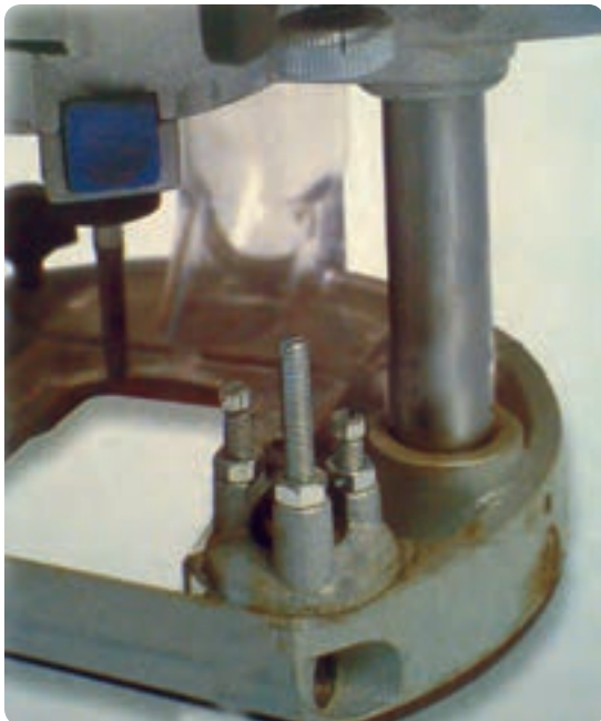
شکل ۴۴-۲ پیچ‌های تنظیم ارتفاع اور فرز دستی برقی
