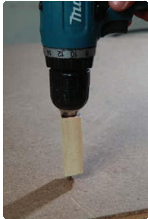
شکل ۳-۳۲ سوراخ دریل قطعه کنترل اندازه عمق
