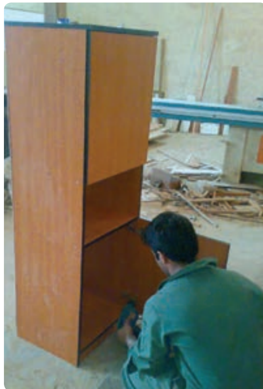
شکل ۱۲۲-۶ نصب در به کمد با لولا کابینتی فردار
