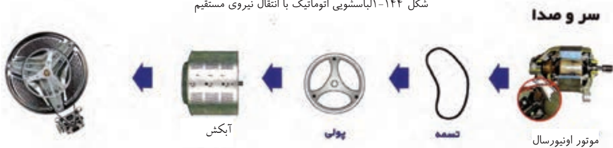
شکل ۱-۱۴۵-الباسشویی اتوماتیک با انتقال نیروی غیرمستقیم
