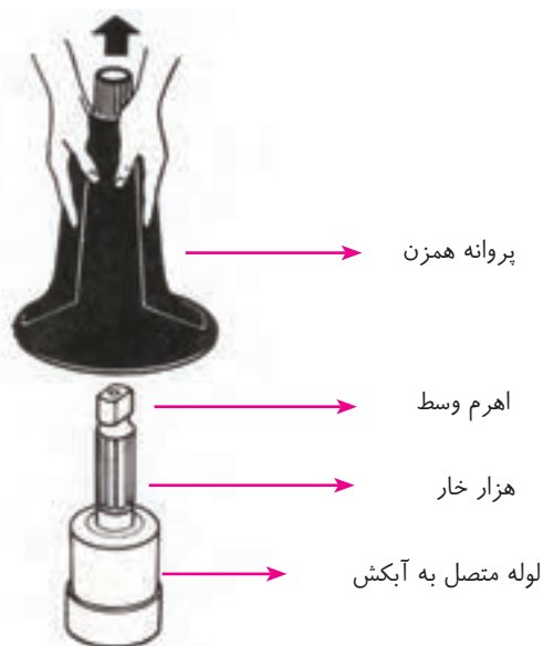
شکل ۱۰۳-۱ نحوه بیرون آوردن پروانه همزن
