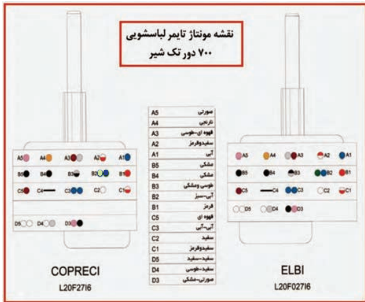
شکل ۱-۱۶۵- نقشه مونتاژ تایمر لباسشویی ۷۰۰ دور تک شیر
