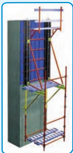
شکل ۲۰-۳- قالب رونده (لغزنده)
