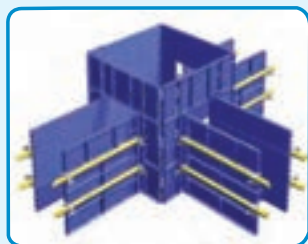
شکل ۳-۲۸- قالب فلزی برای اجرای پی
