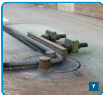
شکل ۳-۶۴ - خم کردن میلگرد
