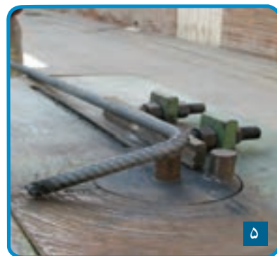
شکل ۳-۶۴ - خم کردن میلگرد
