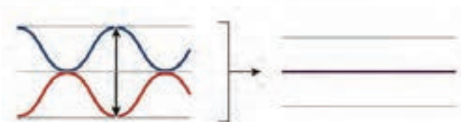
شکل ۵-۶ تأثیر امواج با فاز مخالف
