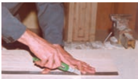
شکل ۵-۲۹- برش (روکش با کاتر)
