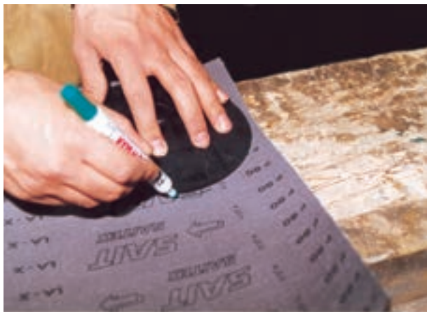
شکل ۷-۳۵- ترسیم گردی دیسک روی سنباده.
