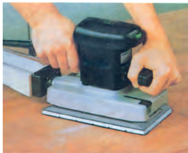
شکل ۳-۱۴- سنباده‌زنی با یک دستگاه سنباده لرزان کامل.
