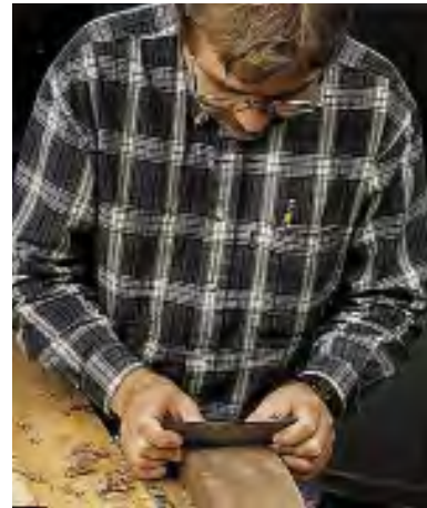
شکل ۲-۳۰. پرداخت سطوح قوس دار به وسیله لیسه.
