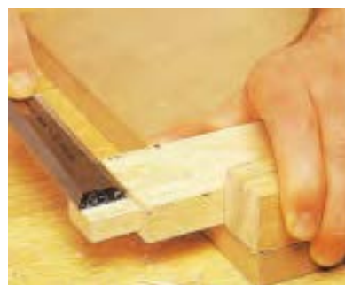
شکل ۹۸- اندازه کردن زبانه با مغار.
