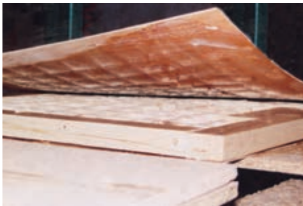
شکل ۱۱-۳۷- قرار دادن صفحه‌ی دوم، روی کلاف.
