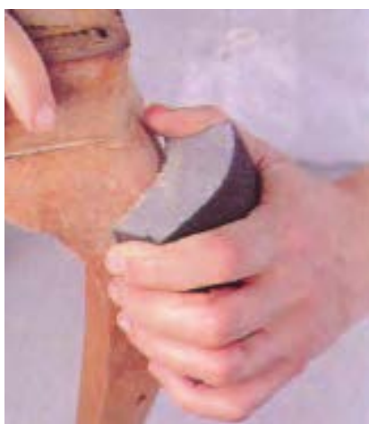
شکل ۳-۲۶- سنباده کاری قوس یک پایهی سم آهویی.
