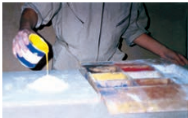
شکل ۴-۳- مواد تشکیل دهنده‌ی بتونه (روغنی).
