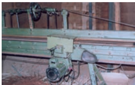
شکل ۵-۲۵- یک دستگاه درز کن (روکش).
