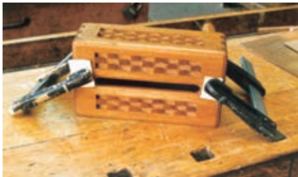
شکل ۹-۷۰- بستن سقف به بدنه‌ها.
