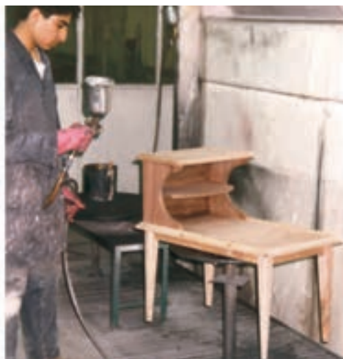
شکل ۴-۲۴. رنگ‌کاری با پیستوله (رنگ شفاف).
