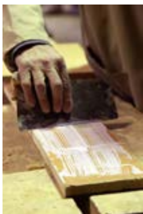
شکل ۴-۱۴. شانه‌ی چسب‌زنی معمولی (کاردک) که با دست روی صفحه‌ی کار هدایت می‌شود.
