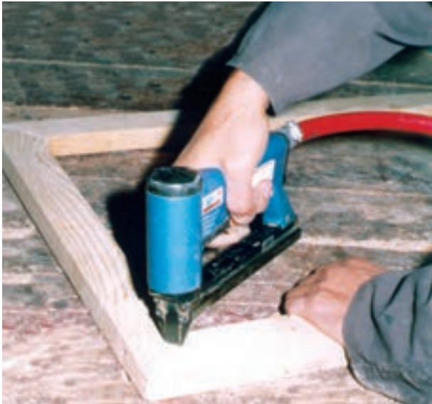
شکل ۸-۱۶- منگنه (زن روی درزهای ۴۵ درجه شده.
