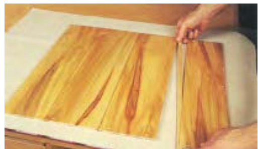
شکل ۵-۲۶- جور کردن (روکش‌ها)
