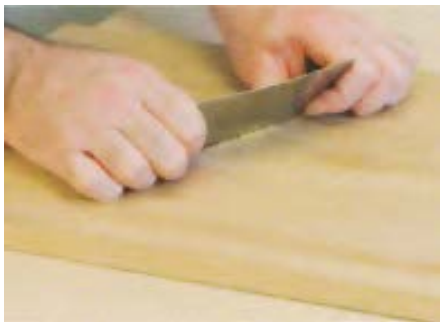
شکل ۲-۱۳. جهت حرکت لیسه، هنگام پُرزگیری.
