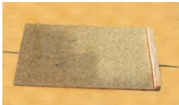
شکل ۹-۶۷- پس‌باندن زهوار به لبه‌ی کف جعبه.
