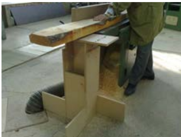
شکل ۹-۱۴- کاربرد میز کمکی برای ماشین کفرند.
