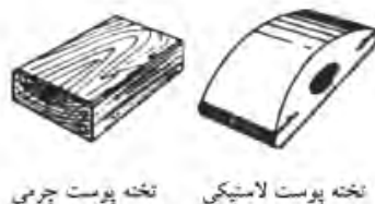
شکل ۷-۱- تخته پوست چوبی و شیوه‌ی صمب کار با آن.
