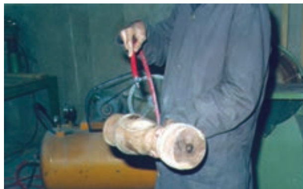
شکل ۲۸-۳. بادگیری قطعات سنباده فورده.
