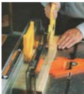
شکل ۱۲-۳- استفاده از وسایل کمکی در هنگام کار.
