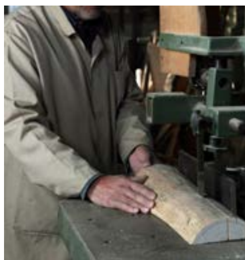
شکل ۴-۹- دستگاه هدایت، حداقل ۲ سانتی متر از سطح کار، بالاتر باشد.
