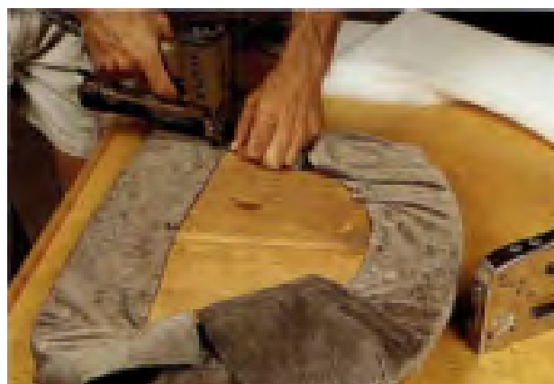
شکل ۸-۵. کاربرد منگنه در (ویه‌کوبی).
