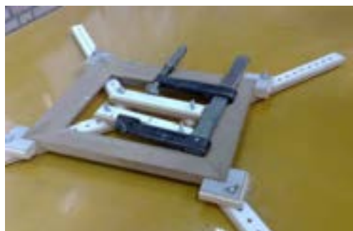
شکل ۹-۷۴. نمای کلی گیره‌ی چوبی، که یک قاب عکس را در فود جای داده و محکم گرفته است.
