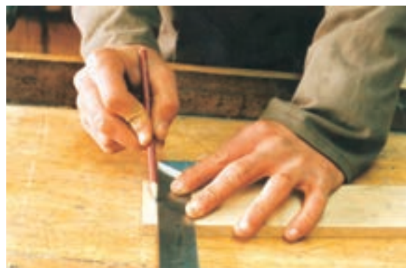
شکل ۹-۶۸- فم کشی ممل اتصال با گونیا.
