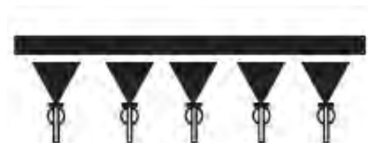
شکل ۴-۴۹. پیستوله نسبت به سطح کار کاملاً عمود قرار گیرد.
