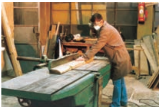
شکل ۹-۹- مقدار باز بودن زیاد گونیا، فطرآفرین است.
