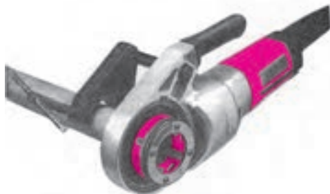
ب - دستگاه حديد هيدروليكي شکل ۱۱-۴ - حديدی لوله فولادی
