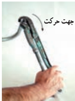
شکل ۴-۹ — طریقه‌ی باز و بسته کردن لوله به وسیله‌ی آچار لوله‌گیر
