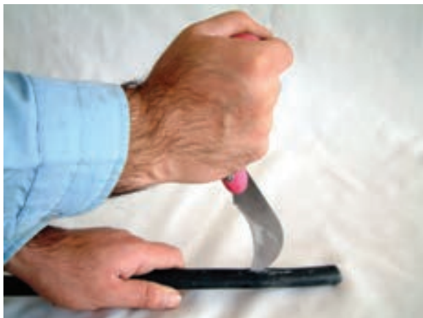
الف - نحوه‌ی غلط لخت کردن کابل
