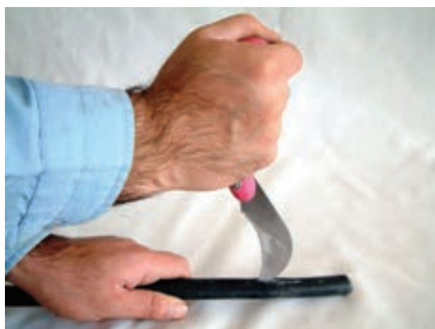
شکل ۵-۳۲ روکش برداری غلط
