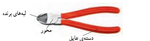
شکل ۱-۳ دو نمونه انبردست دسته عایق
