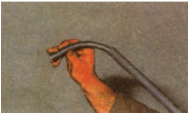
شکل ۴-۴۴ — قرار دادن فنر خم‌کاری در داخل لوله
