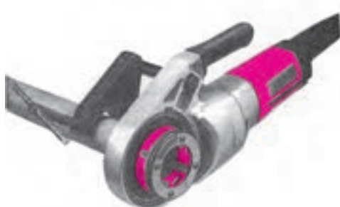
ب - دستگاه حديد هيدروليكي شكل ۱۱-۴ حديد‌ی لوله فولادی
