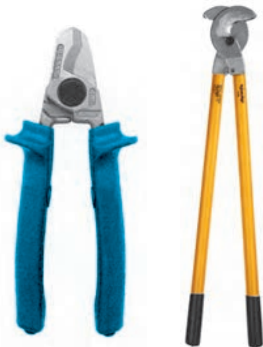
شکل ۱۲-۵- نمونه‌هایی از قیچی کابل‌بری دستی
