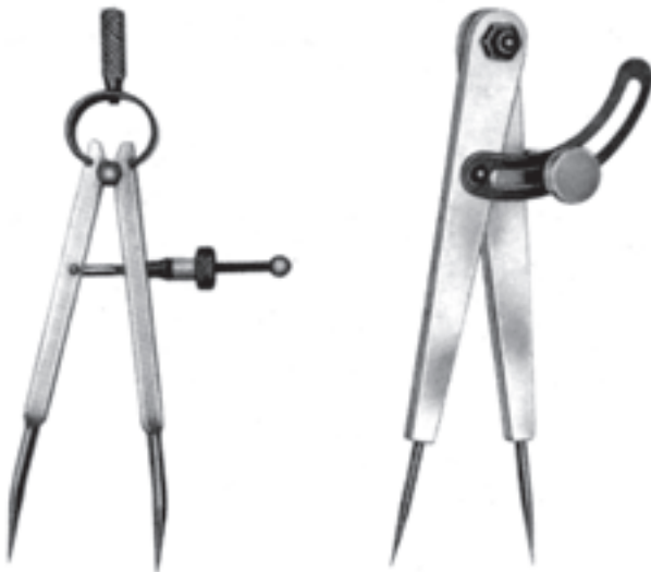
ب - پرگار فنی با پیچ تنظیم
