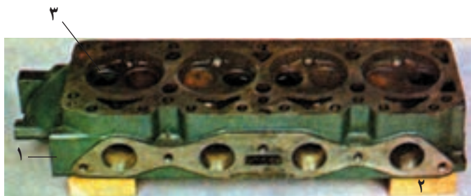
۱- سرسیلندر ۲- قطعه چوب ۳- نشیمنگاه شکل ۱۵-۸
