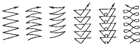
شکل ۳-۳۲- حالت‌های مختلف حرکت نوسانی نوک الکتروود
