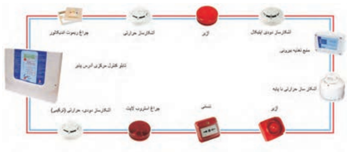
شکل ۱-۲ سیستم اعلام حریق آدرس پذیر
