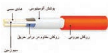
شکل ۱-۲۴ قسمت‌های مختلف یک کابل اعلام حریق
