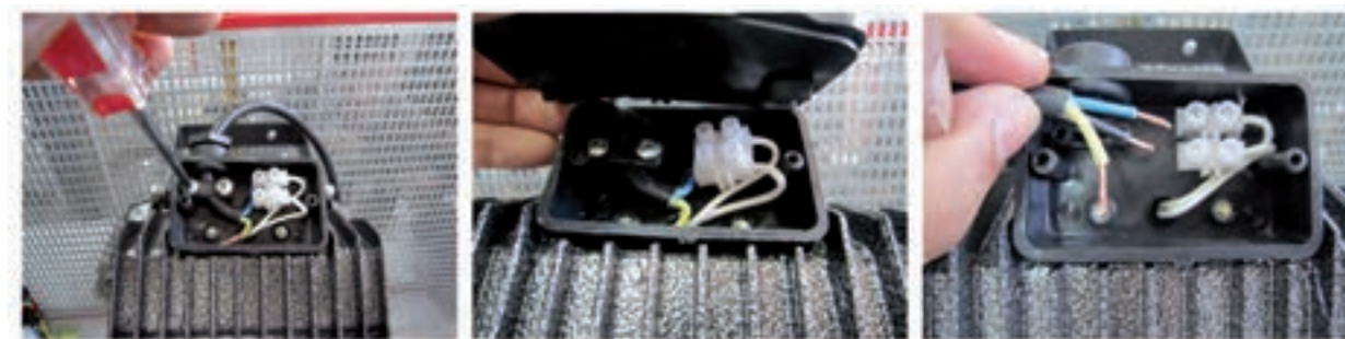
شکل ۲-۲۵ - سیم کشی در جعبه اتصالات
