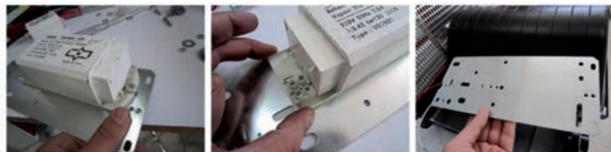
شکل ۲-۳۹ - نحوه نصب بالاست در نورافکن
