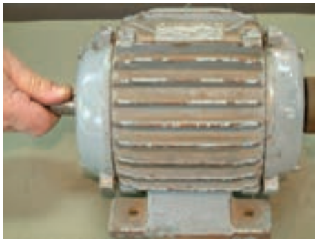
شکل ۴۵-۱- بررسی لقی بوش‌ها
