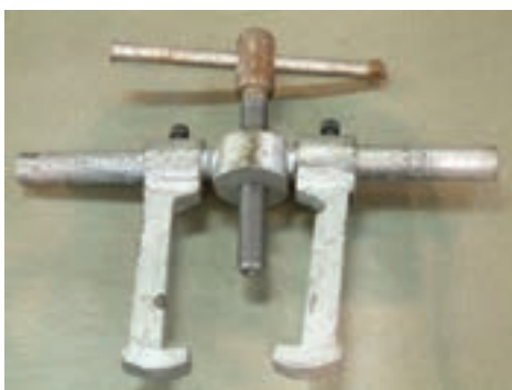
شکل ۴۸-۱- ابزار درآوردن بوش و یاتاقان‌های استوانه‌ای
