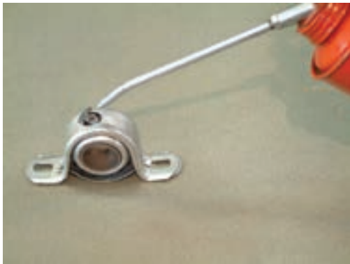
شکل ۱-۳۴- روغن کاری یاتاقان ها
