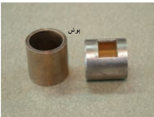
شکل ۳۸-۱- یاتاقان (بوش و کاسه نمد)
