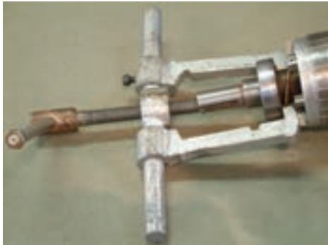
شکل ۴۶-۱- استقرار بلبرینگ کش روی محور روتور
