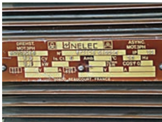
شکل ۲۰-۱- پلاک الکتروموتور سه فاز
