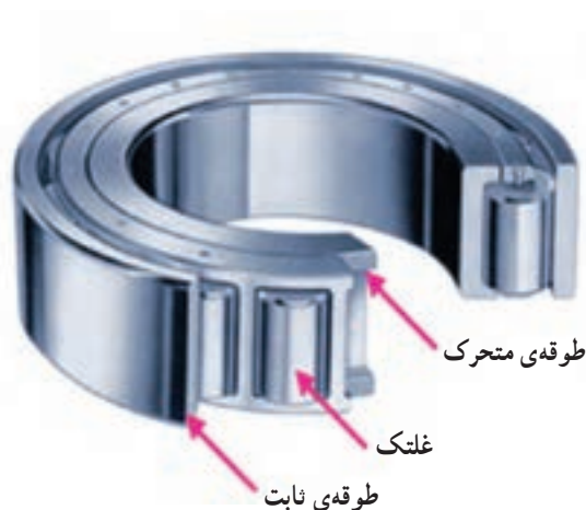
شکل ۱-۳۷ - ساختمان رولبرینگ
