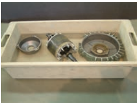
شکل ۱-۳۲ - شست‌وشوی قطعات با آب گرم
