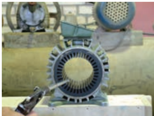
الف – پاک‌سازی خرده سیم‌ها به وسیله‌ی هوای فشرده
