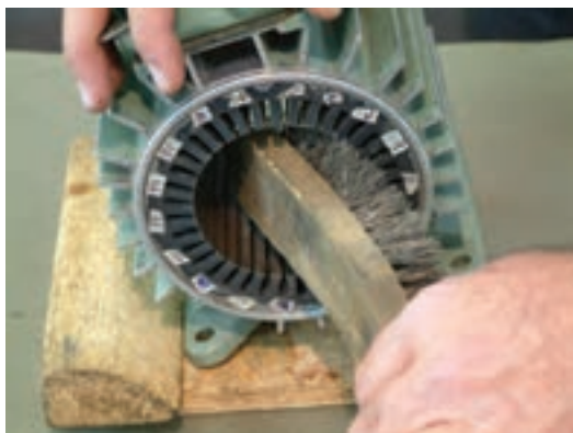
ب – تمیز کردن استاتور با برس سیمی
