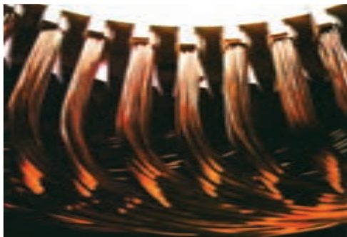
شکل ۲-۳۰- عایق گذاری بین طبقات
