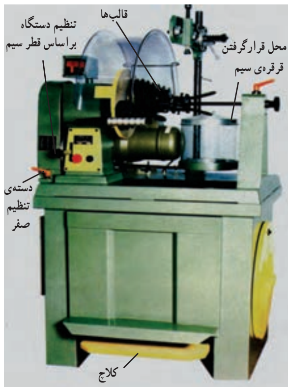
شکل ۱۳-۳- ماشین کلاف پیچ
