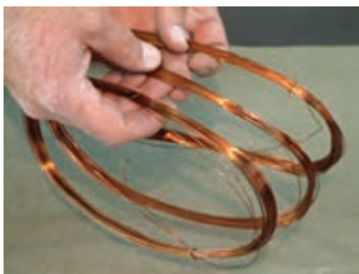
شکل ۱۹-۳ درآوردن کلاف از قالب
