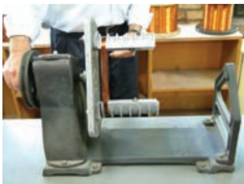
شکل ۱۷-۳ پیچیدن سیم‌ها روی قالب‌ها
