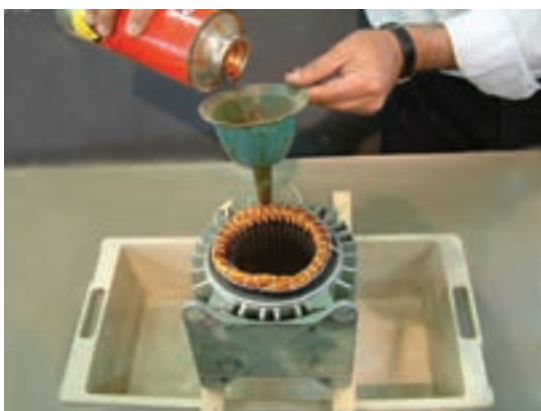
شکل ۲۵-۴ – ریختن شارلاک روی سیم‌ها
