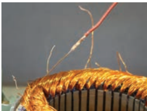
شکل ۴-۱۱- اتصال سیم‌های افشان به سیم‌های لاک‌ی
