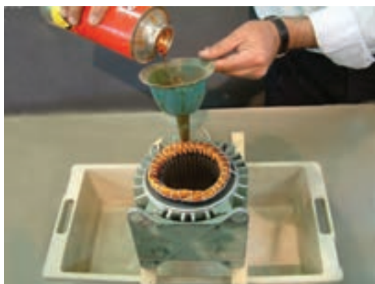
شکل ۴-۲۵- ریختن شارلاک روی سیم ها
