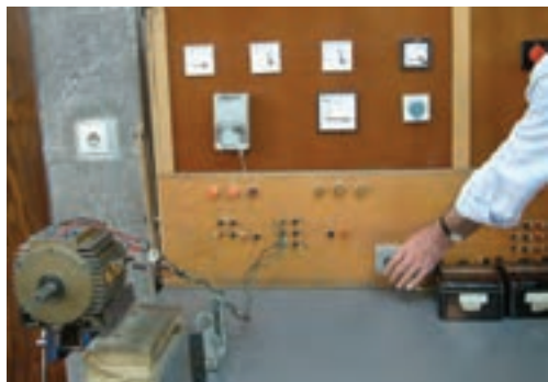
شکل ۶-۹- اتصال موتور به تابلوی برق
