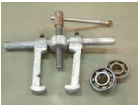
شکل ۱-۴۷ - بلبرینگ‌ها پس از جدا شدن از محور
