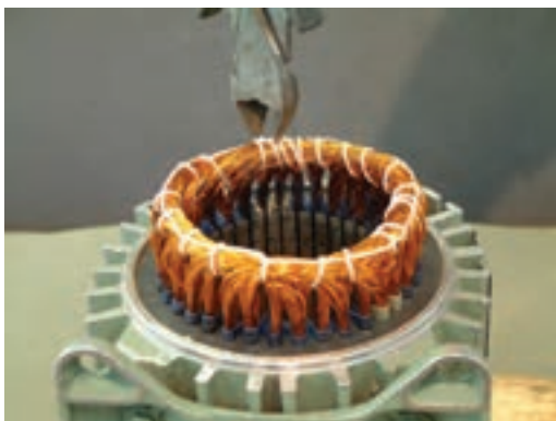
شکل ۲-۱۳ – چیدن نخ‌های کلاف‌بندی با سیم‌چین
