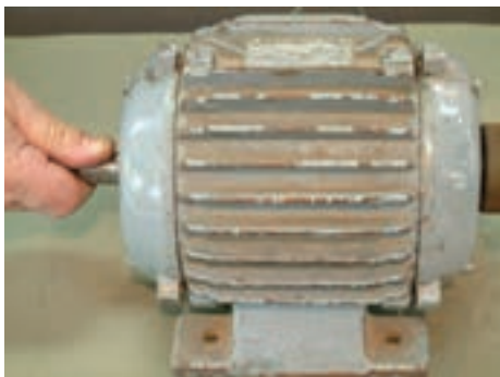
شکل ۱-۴۵ - بررسی لقی بوش‌ها
