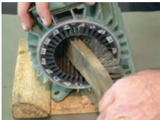
ب – تمیز کردن استاتور با برس سیمی
