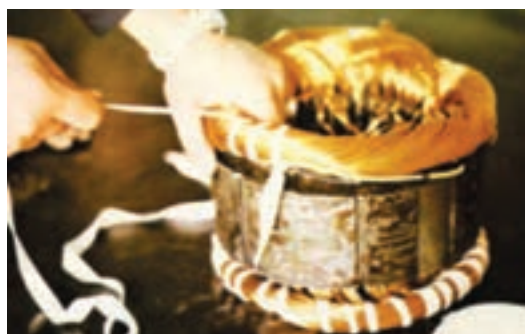
شکل ۴-۱۸– نواربندی سیم‌های استاتور
