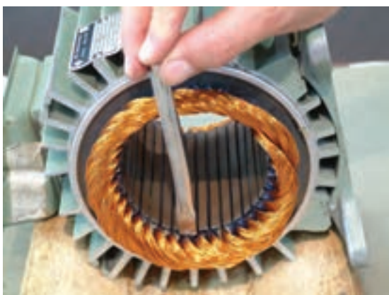
الف- قرار دادن قلم روی سیم‌ها
