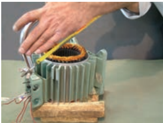
شکل ۱۶-۲ – برش پیچک‌ها و شمارش تعداد دور
