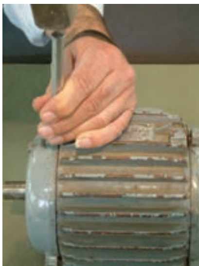
شکل ۱-۲۳- علامت‌گذاری روی پوسته و درپوش‌ها
