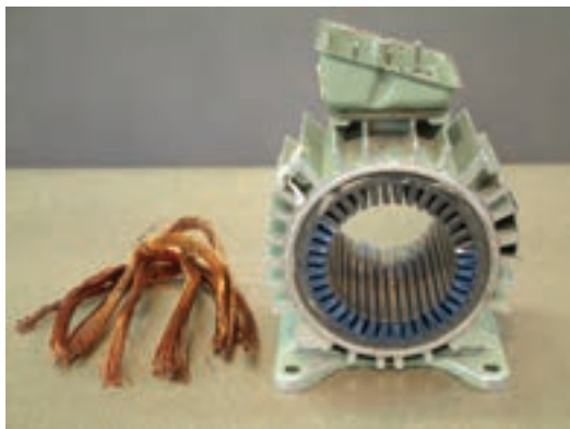
شکل ۲-۲۴ - سیم‌های بیرون آمده از استاتور
