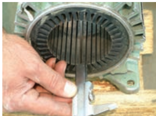
شکل ۲۶-۲- اندازه گیری محیط داخلی و طول شیار
