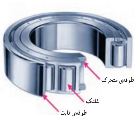
شکل ۱-۳۷- ساختمان رولبرینگ
