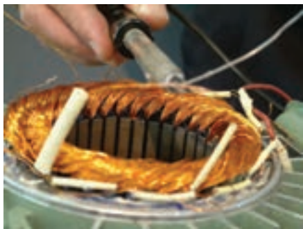
شکل ۴-۷- لحیم کاری محل اتصال سیم ها
