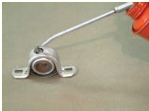
شکل ۱-۳۴- روغن کاری یاتاقان ها
