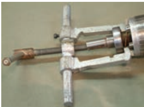
شکل ۱-۴۶ - استقرار بلبرینگ کشر روی محور روتور
