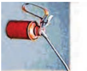
شکل ۱-۳۴- روغن کاری یاتاقان ها
