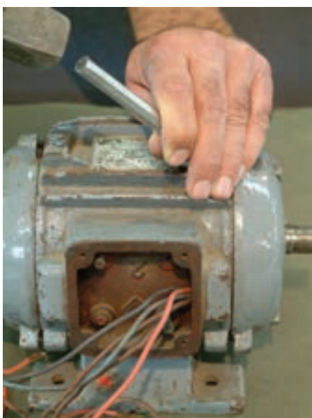
شکل ۱-۲۶ باز کردن درپوش موتور
