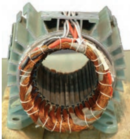
شکل ۴-۱۷– نمایش استاتور نخ‌بندی شده از دو سمت
