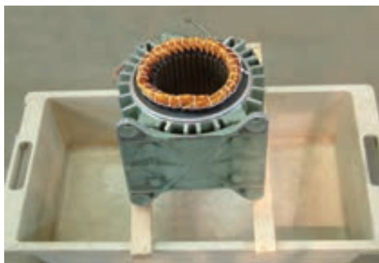
شکل ۴-۲۴- قرار دادن استاتور روی وان
