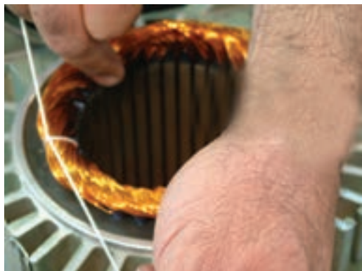
شکل ۴-۱۴- گره زدن یک سر نخ
