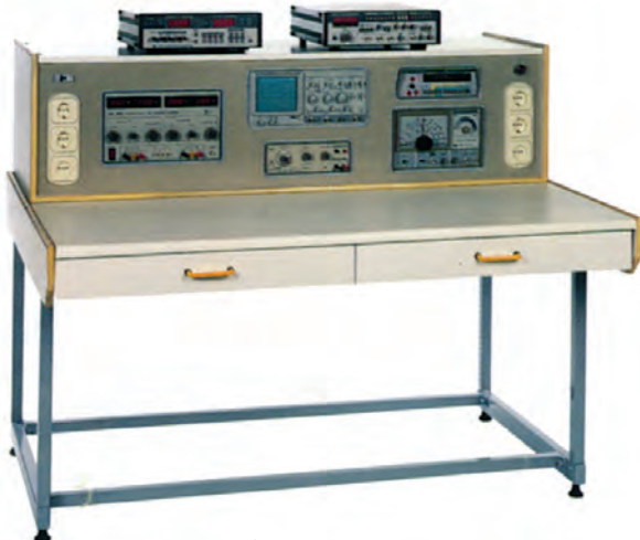
شکل ۱-۹- میزکار آزمایشگاه الکترونیک
