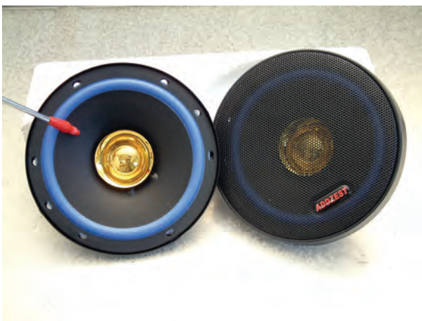
شکل ۳۷-۱ خود بلندگو را از نظر وجود سوراخ، آسیب‌مخروط، جدا شدن و یا قطع شدن در سیم‌پیچ بررسی کنید.
