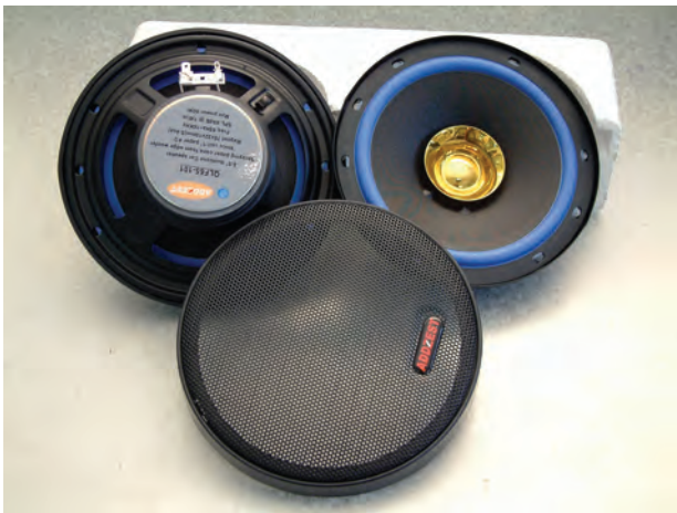
شکل ۳۶-۱ در مواردی که صدا قطع و وصل می‌شود باید اتصال‌های بلندگوها، مدارهای کنترل، سیم‌پیچ‌های صوتی و کابل‌ها را بررسی کنید.
