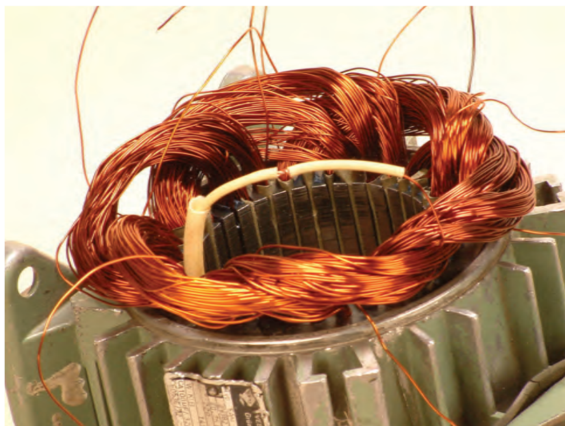
شکل ۳-۹- هدایت وارنیش‌ها به محل لحیم شده
