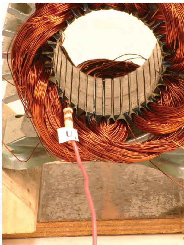
شکل ۱۱-۳- اتصال سیم افشان به ابتدا و انتهای فاز و برجسب زدن آن
