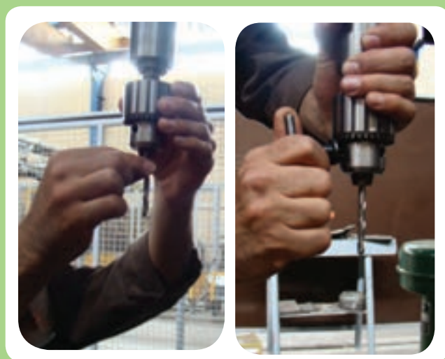
بستن مته به سه نظام آچارخور و یا سه نظام سریع
