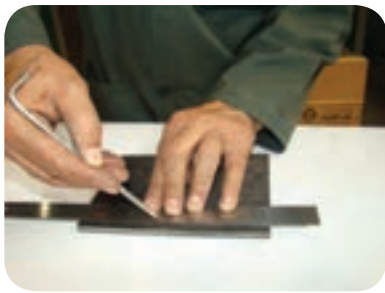
علامت گذاری با استفاده از خط کش و سوزن خط کش روی ورق فولادی
