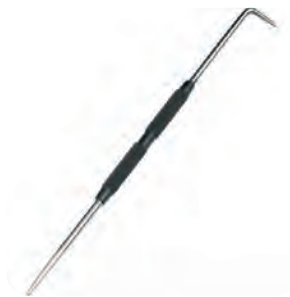
سوزن خط کشی روی قطعات فلزی
