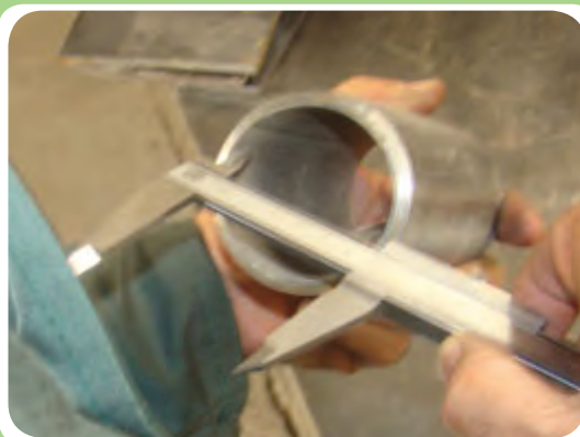
اندازه‌گیری قطر داخلی لوله توسط کولیس
