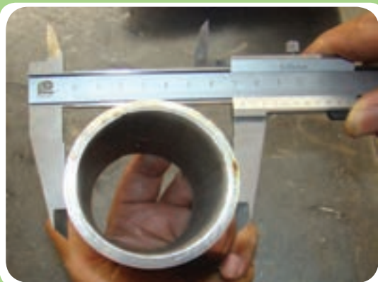
اندازه‌گیری قطر خارجی لوله توسط کولیس
