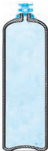
کپسول فولادی مخصوص برای ذخیره اکسیژن
