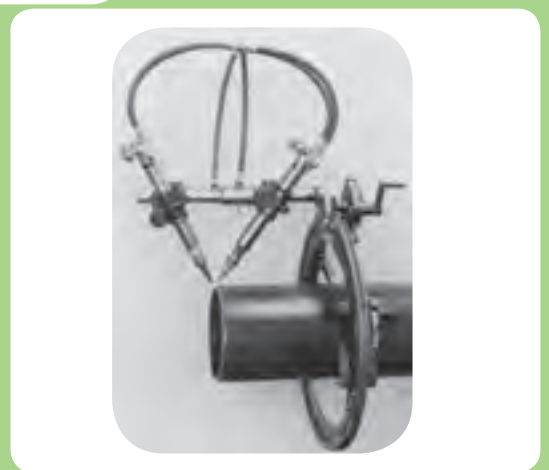
برشکاری و پخ‌سازی لوله فولادی به‌طور هم‌زمان
