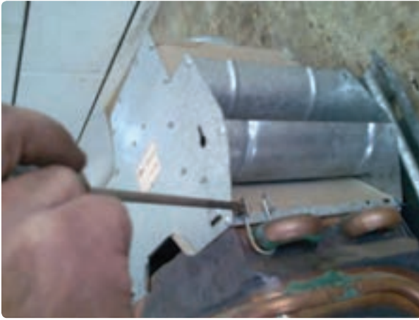
شکل ۶- جدا کردن کلاهک تعدیل از مبدل
