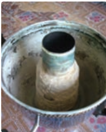
شکل ۸- تشکیل رسوب در سماور و لوله‌ها
