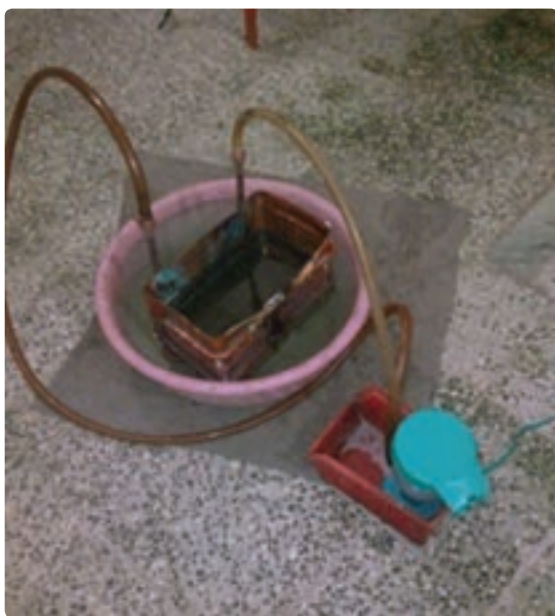
شکل ۱۹- رسوب‌زدایی با پمپ
