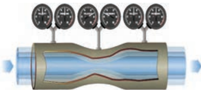
شکل ۳۳- تغییرات فشار و سرعت در یک شیبوره
