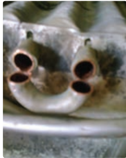
شکل ۱۳- تشکیل رسوب در نقطه بالای شمعک
