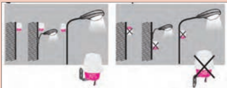
شکل ۹۸- نحوه نصب فتوسل
