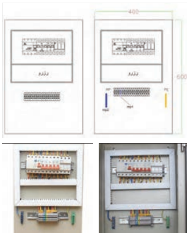
شکل ۵۴- ب) درپوش گذاری داکت‌ها و نصب صفحه نصب داخل تابلو
