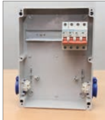
شکل ۲۲- نصب کلید جریان باقیمانده (نشتی)
