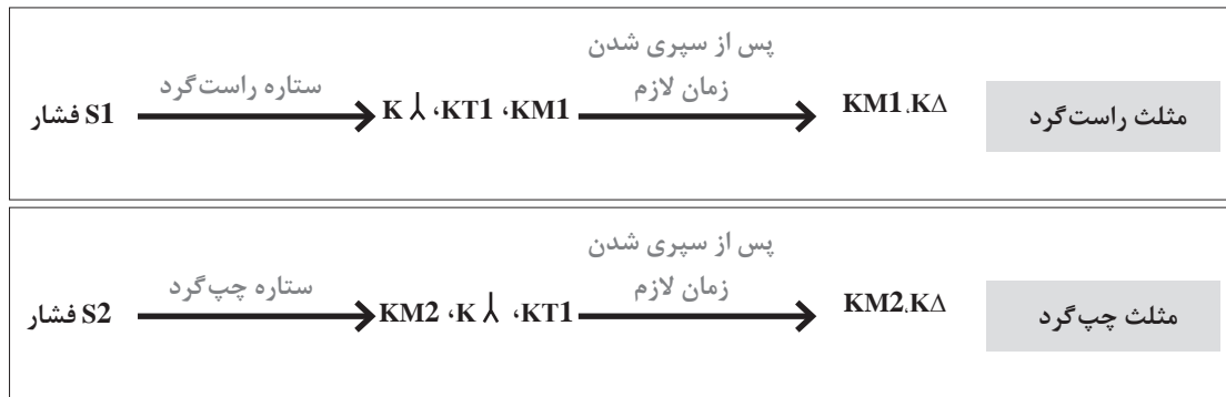
شکل ۲۶- نحوه عملکرد قطعات در مدار فرمان
