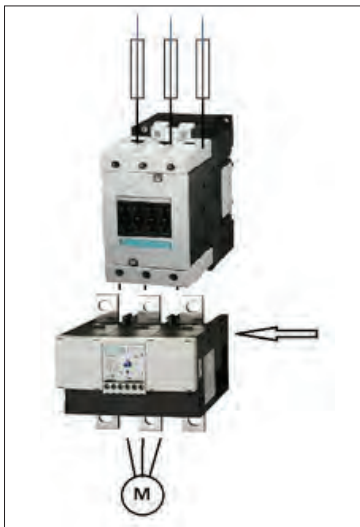
شکل ۳۹- رله اضافه بار شینه دار
