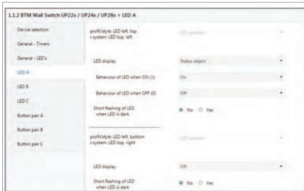
شکل ۶۰- ب - تنظیمات پارامترهای کلید دیواری
