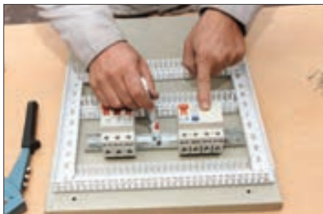
شکل ۴۲- محل نصب ریل فلزی
