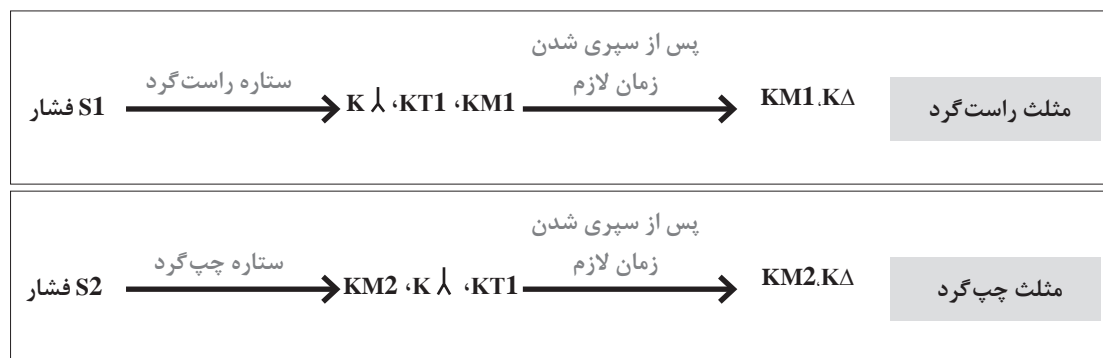
شکل ۲۶- نحوه عملکرد قطعات در مدار فرمان
