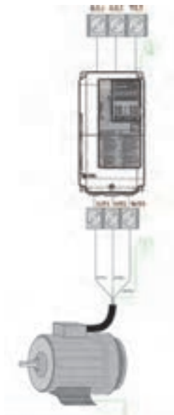
شکل ۳- ب) نحوه اتصال موتور الکتریکی به اینورتر
