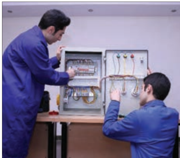
شکل ۲- تابلو برق فشار ضعیف
