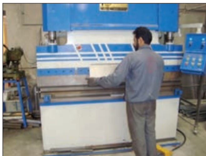
شکل ۱۷- پرس هیدرولیک
