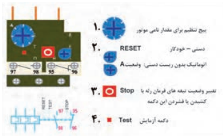
شکل ۵-الف) تنظیم رله اضافه بار یا بی متال
