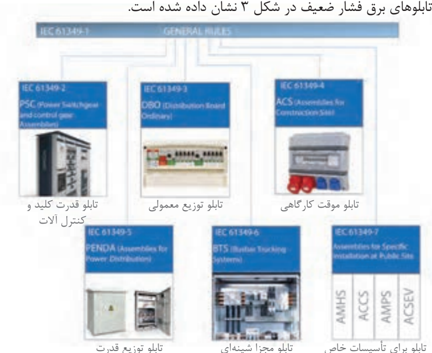
شکل ۳- دسته‌بندی انواع تابلوهای برق فشار ضعیف
