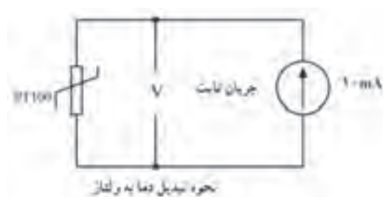
شکل ۳- تبدیل دما به ولتاژ
