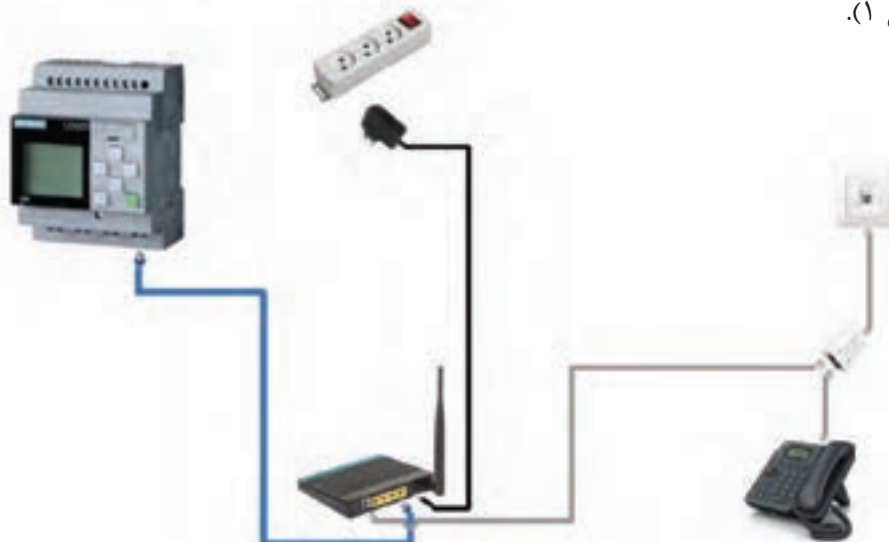
شکل ۱- اتصال رله به شبکه
