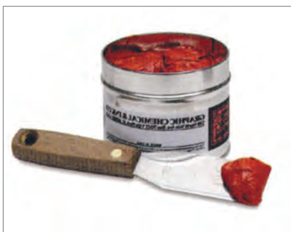
کاردک‌های بزرگ برای برداشتن رنگ ، پاک کردن سطوح ترکیب مل بارنگ و ...
