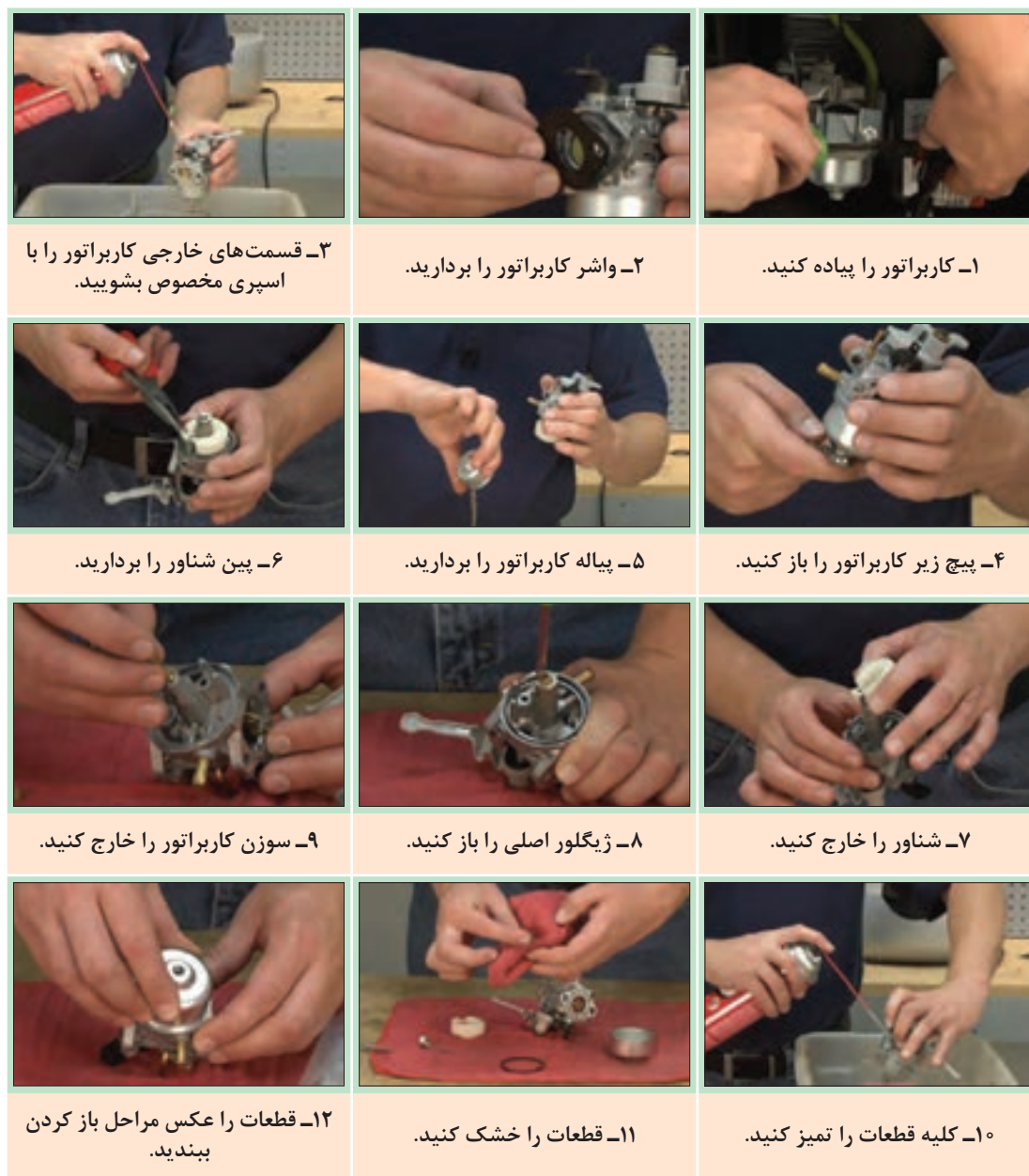
شکل ۲۵- باز کردن و تمیز کردن قطعات کاربراتور
