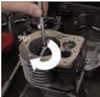
شکل ۲۸- کنترل دو پهنی سیلندر
