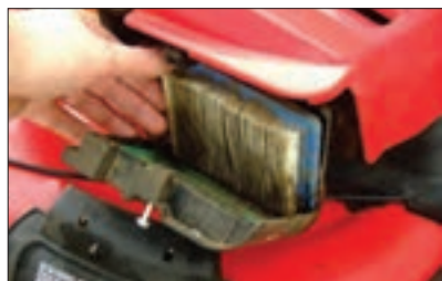
شکل ۱۲- فیلتر هوای کاغذی
