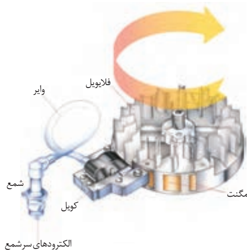
شکل ۷- طرز کار سیستم جرقه‌زنی
