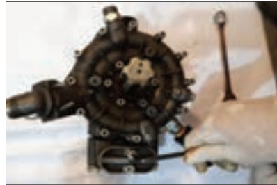
شکل ۴۸- باز کردن درپوش سوپاپ‌ها
