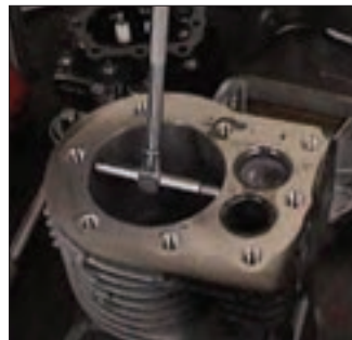
شکل ۲۸- کنترل دو پهنی سیلندر
