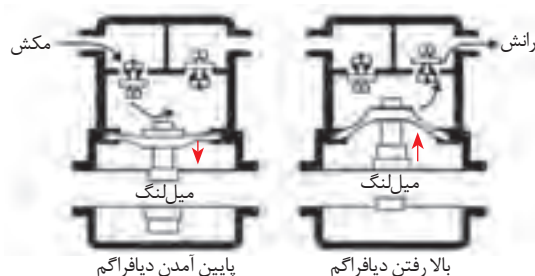
شکل ۴۱- طرز کار پمپ دیافراگمی
