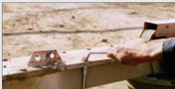
شکل ۲۰- باز کردن پیچ‌های سرپوش جعبه‌دنده
