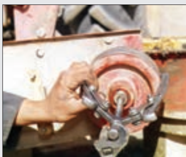
شکل ۱۰- خارج کردن چرخ تسمه
