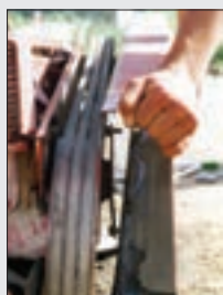
شکل ۸- برداشتن قاب تسمه‌ها
