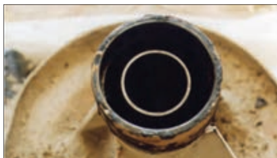
شکل ۴۳- ساییدگی جای بلبرینگ
