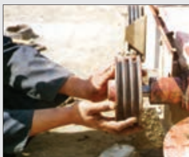
شکل ۱۱- برداشتن چرخ تسمه
