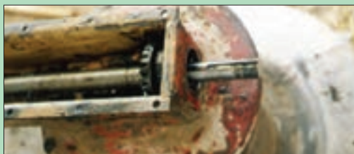
شکل ۲۸- خارج کردن محور افقی از محل درپوش
