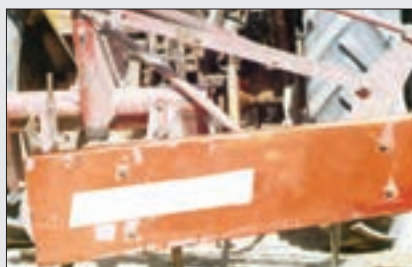
شکل ۷- باز کردن حفاظ تسمه‌ها
