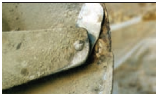
شکل ۴۲- خوردگی لبه استوانه
