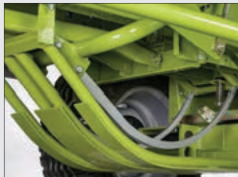
شکل ۶۴- قاب محافظ کمان سوزن
