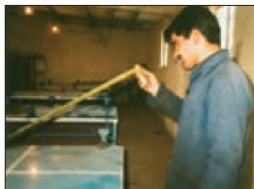
شکل ۱۰- آزمایش کجی محور انگشتی
