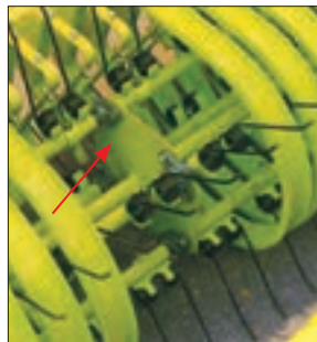
شکل ۱۶- یاتاقان محور انگشتی و محل نصب آن
