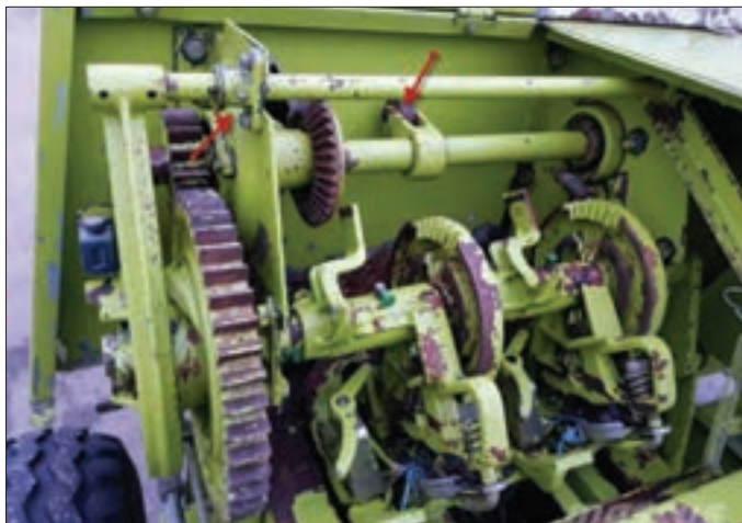
شکل ۷۵- یاتاقان‌ها و نگهدارنده فرمان‌دهنده گره‌زن
