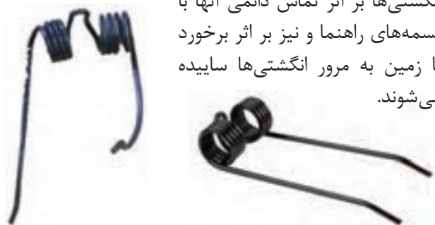
شکل ۴- تفاوت انگشتی سالم و انگشتی معیوب
