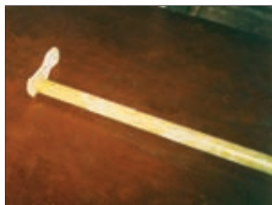
شکل ۱۴- پایه بلبرینگ انگشتی
