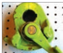
شکل ۷۰- ضامن کلاچ گره‌زن و موقعیت آن روی گره‌زن
