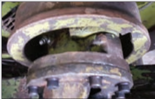
شکل ۴۸- پیچ‌های اتصال کلاچ به یوک چهارشاخه گاردان
