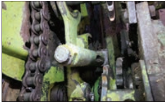
شکل ۴۳- اهرم و پیچ تنظیم تیغه ثابت
