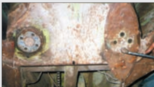
شکل ۳۱- باز کردن تیغه متحرک
