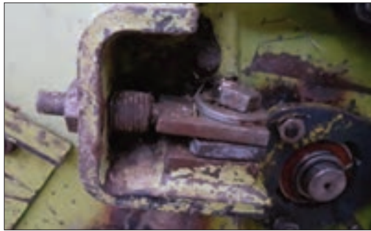
شکل ۴۲- پیچ تنظیم تیغه ثابت
