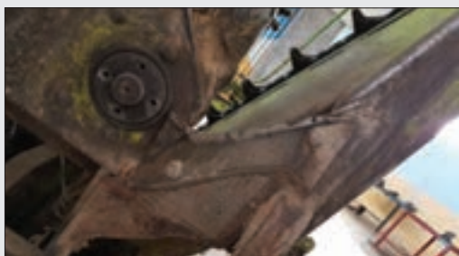
شکل ۳۲- پیچ‌های متصل به تیغه ثابت
