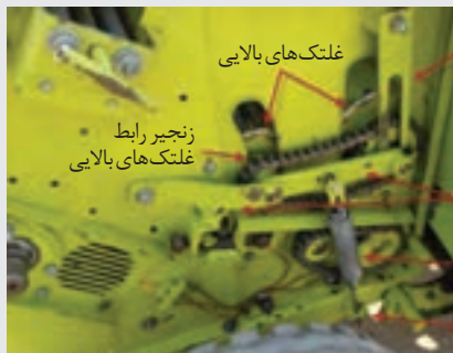
شکل ۴۰- قطعات مرتبط با غلتک‌های بالایی
