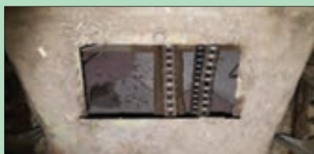
شکل ۲۶- درپوش روغن کاری زنجیر محرک واحد درو
