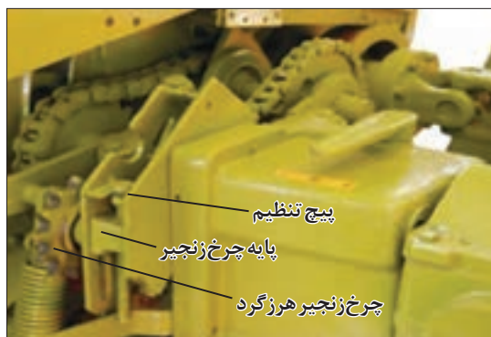
شکل ۷- زنجیر سفت کن با چرخ زنجیر واسطه
