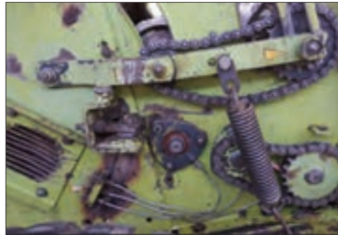
شکل ۳۷- فنر شناوری غلتک‌های بالایی
