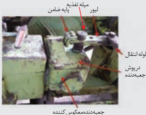
شکل ۹- قطعات بیرونی جعبه‌دنده معکوس کننده
