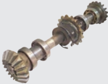
شکل ۳۵- محور افقی و اجزای آن
