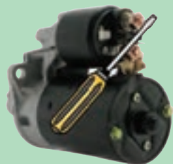
شکل ۴۳- اتصال کوتاه موتور استارت
