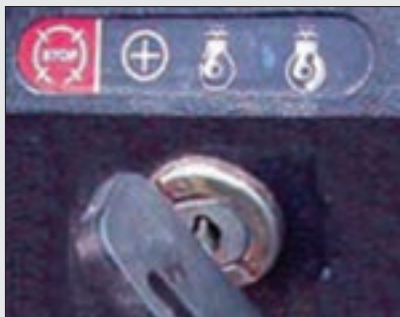
شکل ۹- مراحل سوئیچ تراکتور MF۳۹۹
