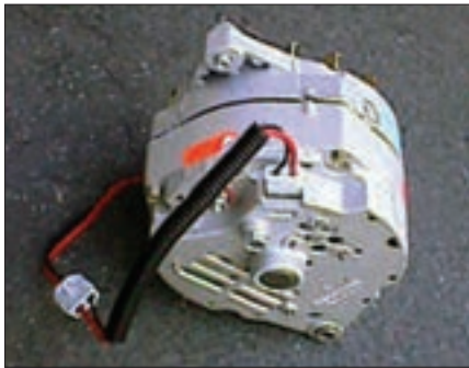
شکل ۱۸- آلترناتور مجهز به آفتامات الکترونیکی
