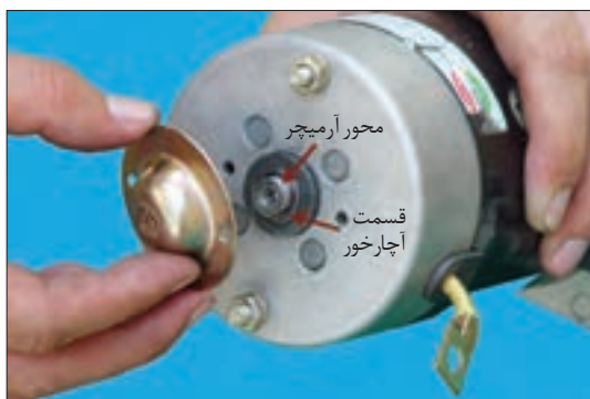
شکل ۴۴- درپوش انتهایی موتور استارت
