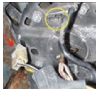
شکل ۲۶- جدا کردن کاتوچویی سیم‌کشی لامپ شارژ
