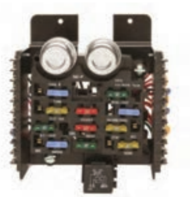
شکل ۸- جعبه فیوز یک نمونه تراکتور
