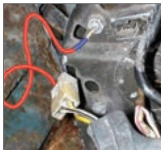
شکل ۲۷- آزمایش مدار لامپ شارژ
