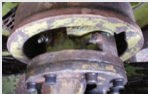
شکل ۴۸- پیچ‌های اتصال کلاچ به یوک چهارشاخه گاردان
