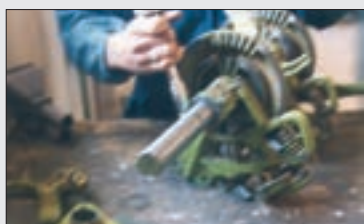
شکل ۷۶- پیاده کردن محور گره‌زن و اجزای آن
