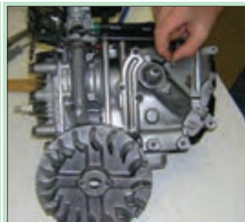
۴- خار مستطیل شکل بین فلایویل و محور میل‌لنگ را بردارید.
