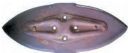
شکل ۱۷- صفحه زیر تیغه متحرک
