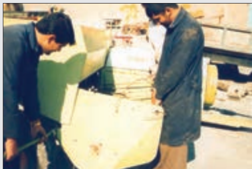
شکل ۳۳- جدا کردن واحد بردارنده
