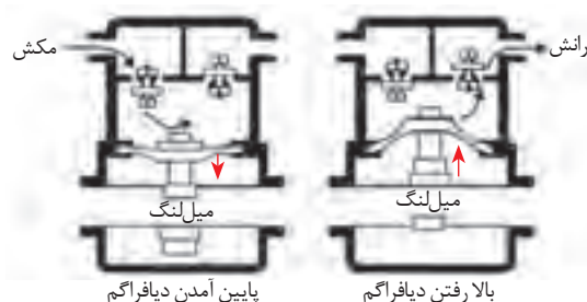
شکل ۴۱- طرز کار پمپ دیافراگمی
