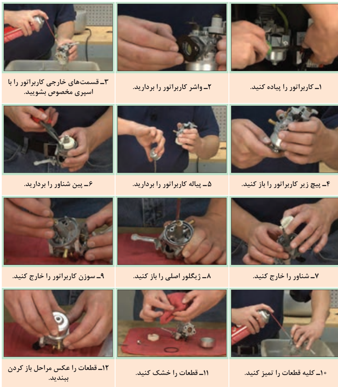
شکل ۲۵- باز کردن و تمیز کردن قطعات کاربراتور
