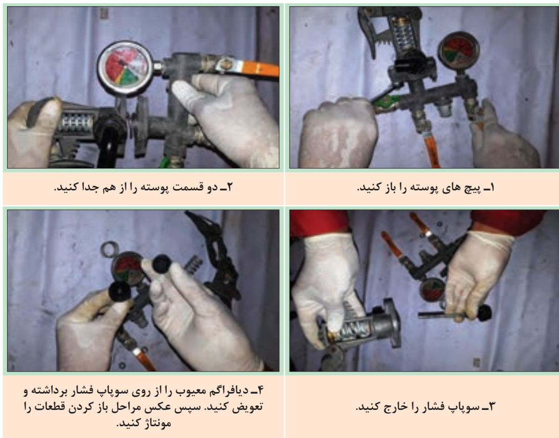
شکل ۵۲- تعویض دیافراگم رگولاتور مدل کمت
