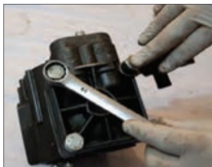
شکل ۴۵- باز کردن درپوش
