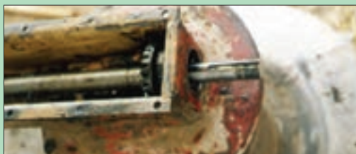
شکل ۲۸- خارج کردن محور افقی از محل درپوش
