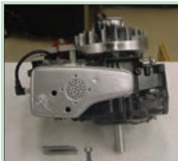
۵- منبع اگزوز را با باز کردن پیچ‌های آن پیاده کنید.
