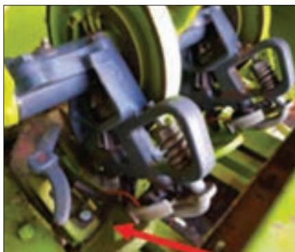
شکل ۳۸- هادی نخ و موقعیت آن روی گره‌زن
