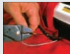
الف) لخت کردن سیم در محل قطعی
