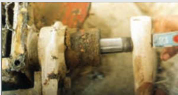
شکل ۲۳- خارج کردن محور ورودی
