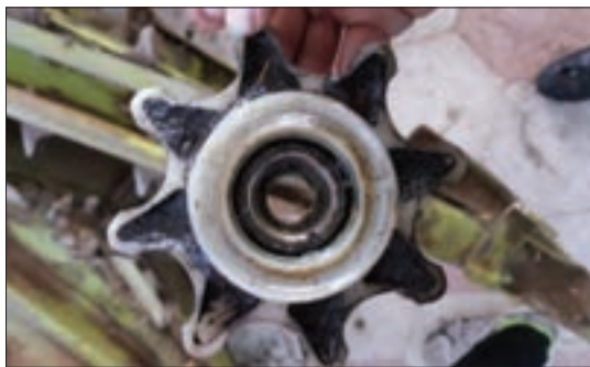
شکل ۱۹- چرخ زنجیر زنجیرهای هدایت‌کننده
