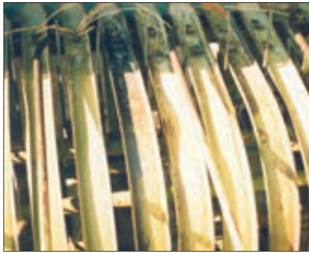
شکل ۶- ساییده شدن انگشتی‌ها به تسمه‌های راهنما
