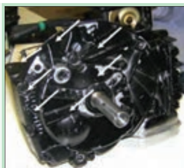
۱۰- درپوش محفظه تایم (سینی موتور) را بعد از باز کردن پیچ‌های آن با استفاده از چکش لاستیکی باز کنید.
