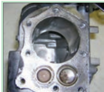
۹- واشر سر سیلندر را برداشته و در محلی قرار دهید که صدمه نبیند. واشر سر سیلندر در صورت لزوم باید تعویض شود.
