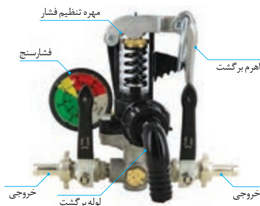
شکل ۴۳- شیر تنظیم فشار مدل کمت
