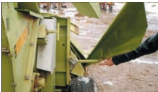
شکل ۲۳- پایه نگهدارنده صفحه جداکننده
