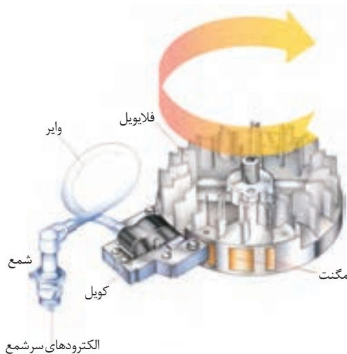
شکل ۷- طرز کار سیستم جرقه‌زنی
