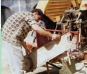
شکل ۱۵- پیاده کردن حفاظ
