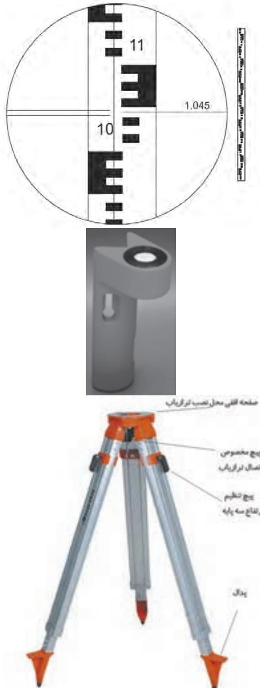
آشنایی با اجزاء مختلف ابزار ترازیابی شامل ترازیاب، سه پایه و شاخص و نحوه استقرار صحیح ترازیاب و شاخص روی زمین و قرائت تارهای رتیکول و ثبت صحیح اعداد روی شاخص و انجام مداوم استقرار دستگاه و قرائت شاخص و ثبت اعداد در مکان‌های مختلف
