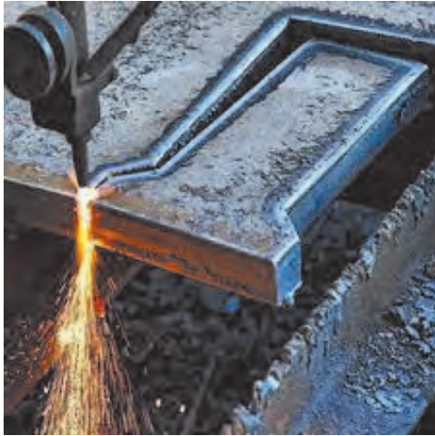
شکل ۴۸ ▲ برش کاری ورق کله‌گای
