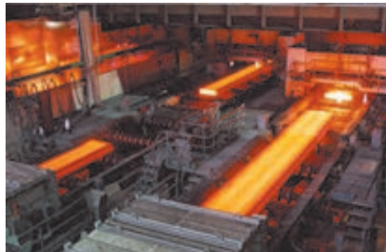
شکل ۳ ▲ نورد گرم ورق فولادی
