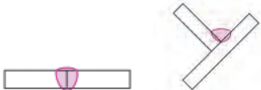
شکل ۷۷ ▲ جوشکاری در وضعیت تخت
