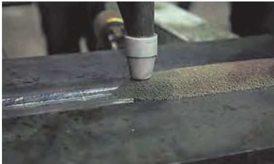
شکل ۷۳ ▲ جوشکاری قوس الکتریکی زیر پودری
