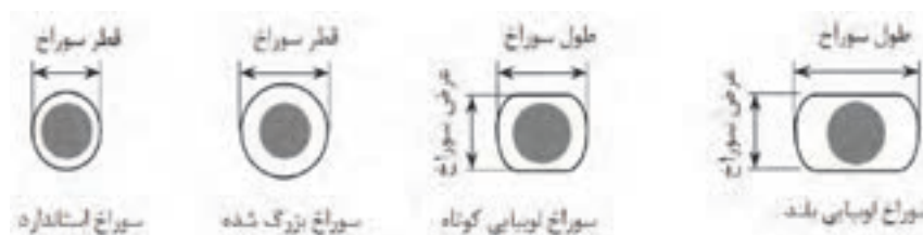
شکل ۹۹ ▲ انواع سوراخ پیچ‌ها در اتصالات پیچی
