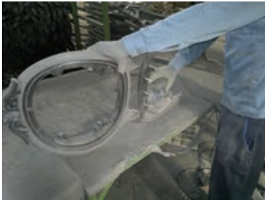
شکل ۵-۳۰- پرداخت با سنباده لرزان
