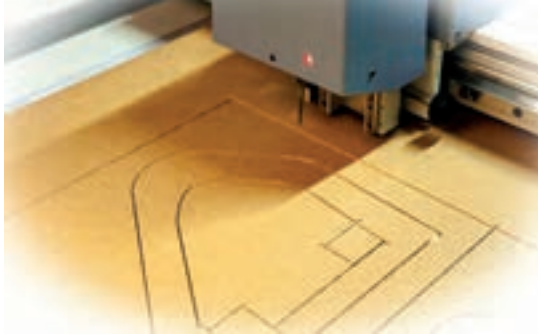
شکل ۵-۵۸- برش مقوا برای ساخت کارتن با سی‌ان‌سی
