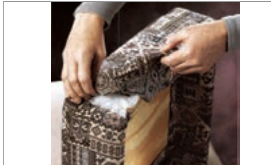
شکل ۴-۳۷- تنظیم پارچه گوشه‌ها
