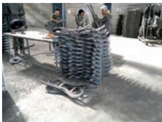
شکل ۵-۳۲ پرداخت کاری قطعات و چیدمان آنها
