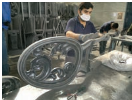
شکل ۵-۲۹ پرداخت با دست
