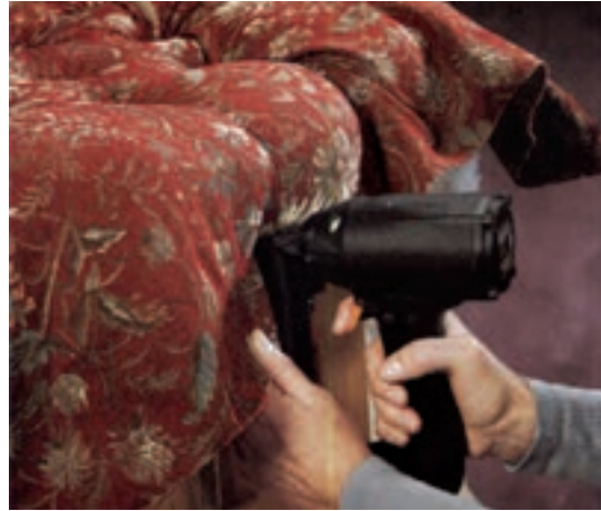
شکل ۴-۶۴- منگنه زدن لبه پایین
