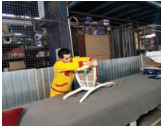
شکل ۵-۷۷- جا زدن و تنظیم پایه جلو
