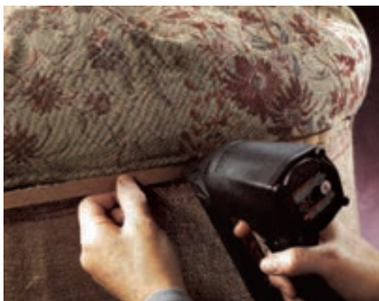
شکل ۴-۷۰- کوبیدن زهوار زیر سرمه با منگنه
