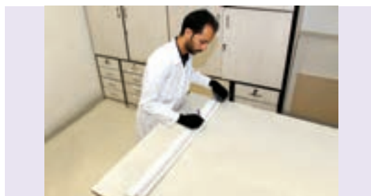
شکل ۲۲۷- ۱- اندازه گیری قطعه کار برای برش
