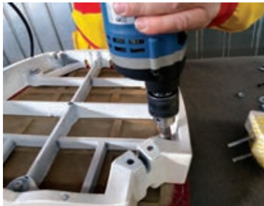
شکل ۵-۷۳- بستن شبکه زیر صندلی به کف
