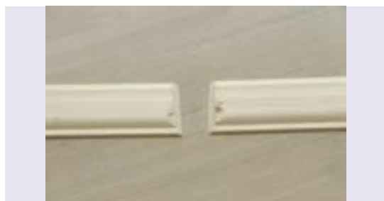
شکل ۲۲۸- ۱- برش فارسی بر قطعات کنج
