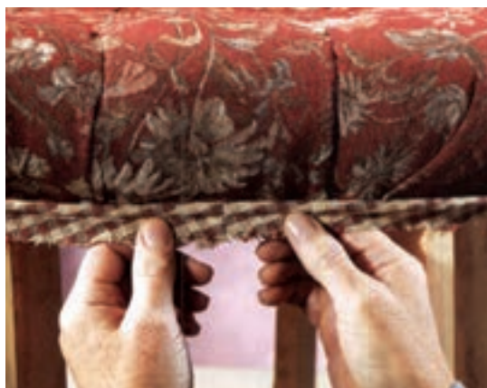
شکل ۴-۶۹- اندازه گیری و نصب سرمه
