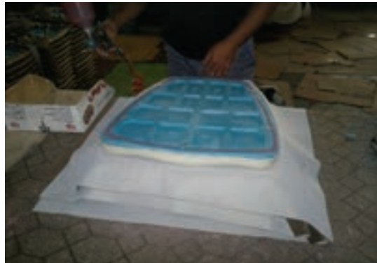
شکل ۵-۴۹- کشیدن پارچه روی کف صندلی
