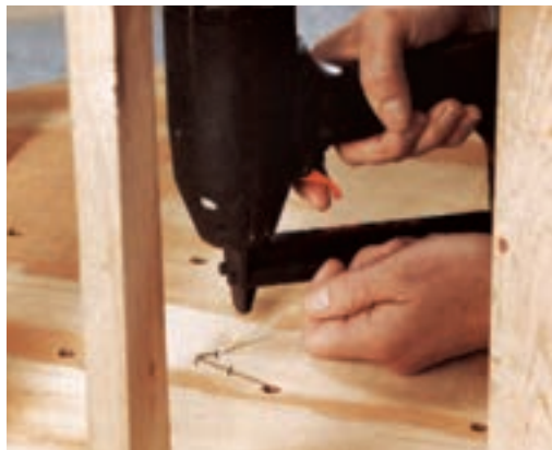
شکل ۴-۶۰- ثابت کردن نخ لمسه از پشت تخته
