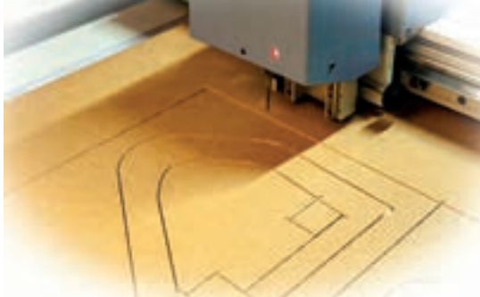
شکل ۵-۵۸- برش مقوا برای ساخت کارتن با سی‌ان‌سی
