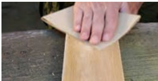
شکل ۴-۲۰- پرداخت با سنباده
