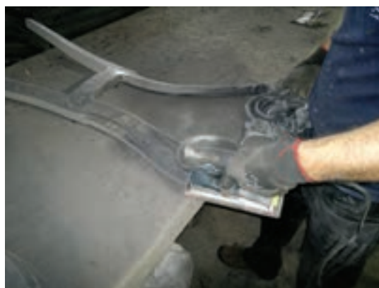
شکل ۵-۳۱ پرداخت پشت صندلی با سنباده لرزان
