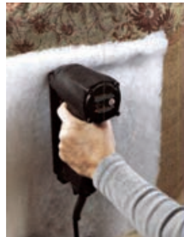
شکل ۴-۶۶- کوبیدن اسفنج بدنه
