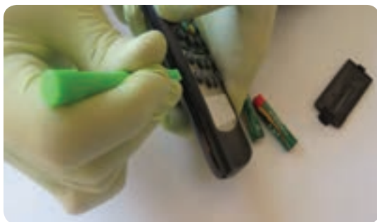
شکل ۸-۱ آزاد کردن خارهای قاب دستگاه ریموت کنترل
