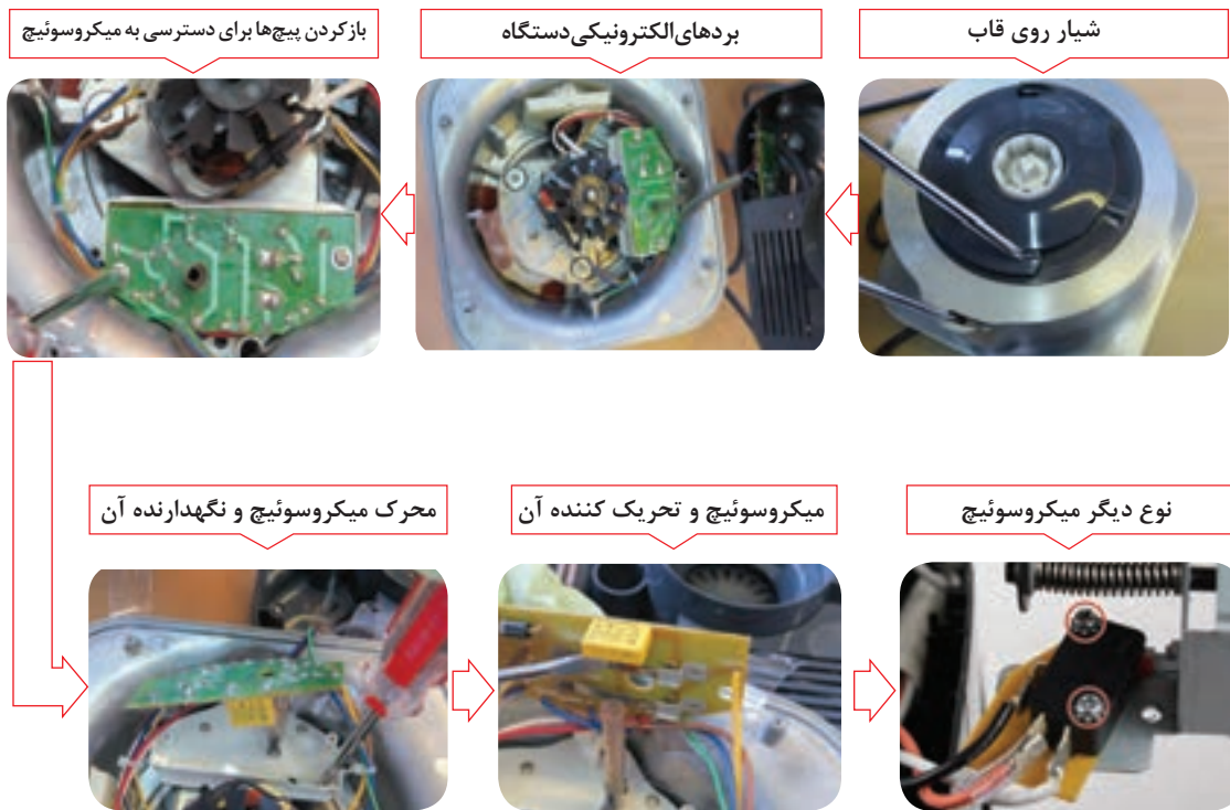
شکل ۲۵-۱- اینفوگرافی جدا کردن میکروسوییچ
