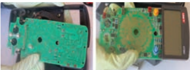
شکل ۱-۱۷- مولتی متر باز شده
