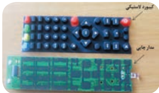
شکل ۴-۱. صفحه کلید و برد دستگاه ریموت کنترل
