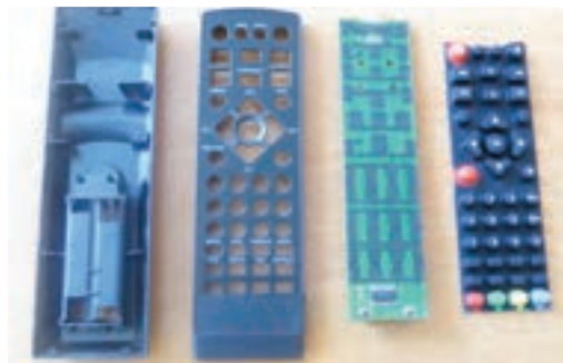
شکل ۳-۱. اجزای دستگاه ریموت کنترل
