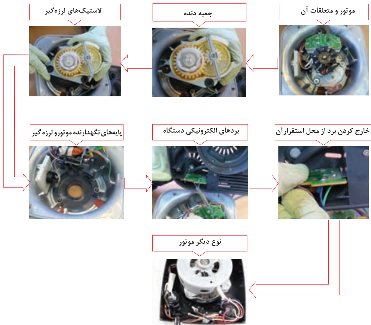
شکل ۱-۲۷- اینفوگرافی جدا کردن برد الکترونیکی دستگاه غذاساز
