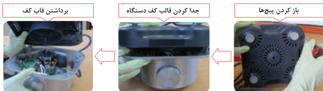
شکل ۲۲-۱- اینفوگرافی باز کردن کف دستگاه
