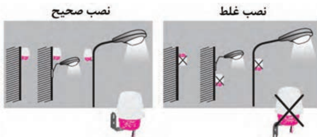
شکل ۱۶-۲- نصب صحیح و غلط فتوسل
