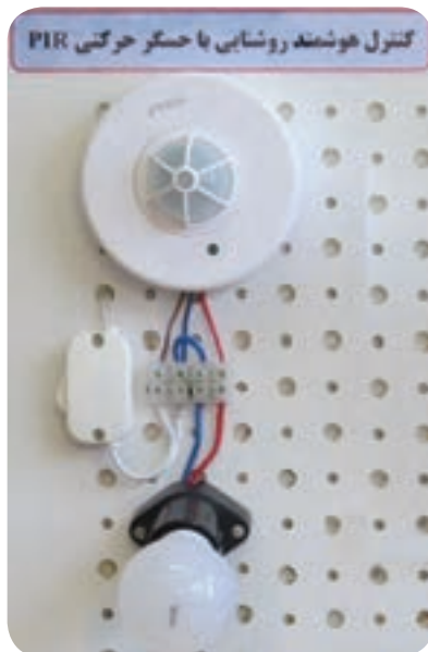
شکل ۲۹-۲- نحوه سیم‌کشی حسگر حرکتی PIR
