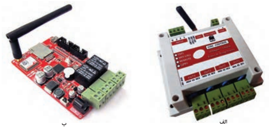
شکل ۲-۵۴ دو نمونه دستگاه کنترل کننده GSM
