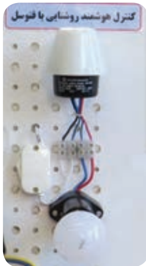
شکل ۲-۱۹- نحوه سیم‌کشی فتوسل
