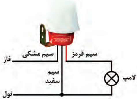
شکل ۲-۱۸- اتصال فتوسل به لامپ و شبکه
