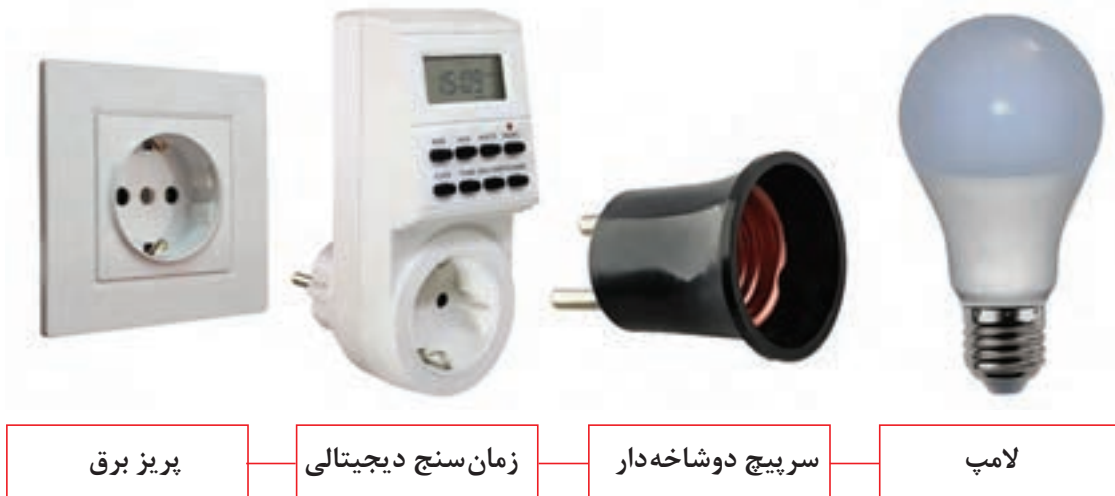
شکل ۲۴-۲- نحوه بستن مدار زمان‌سنج دیجیتالی
