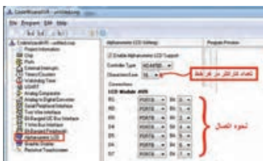
شکل ۴-۸- تنظیم ویزارد برای اتصال LCD به میکروکنترلر
