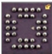
شکل ۳۳ - تصویر ظاهری انواع پکیج‌های BGA
