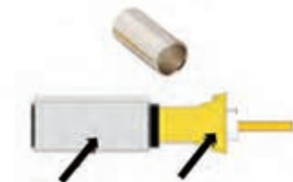
شکل ۳-۲۲- قراردادن حلقه روی کابل
