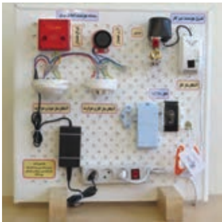
شکل ۳-۵۴- تابلوی اعلام حریق
