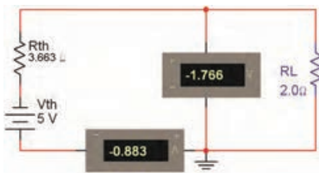
شکل ۸-۱۳- اندازه‌گیری جریان بار در مدار معادل تونن
