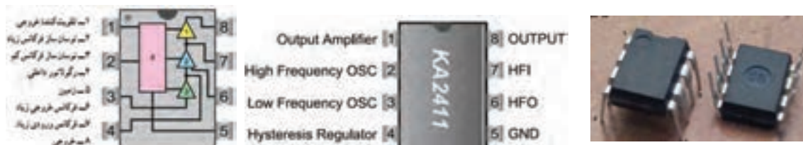
الف - شکل ظاهری آی سی ب - شماره و عملکرد پایه ها پ
