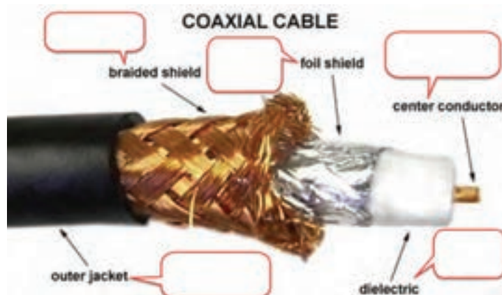
شکل ۴-۵- کابل کواکسیال و اجزای آن
