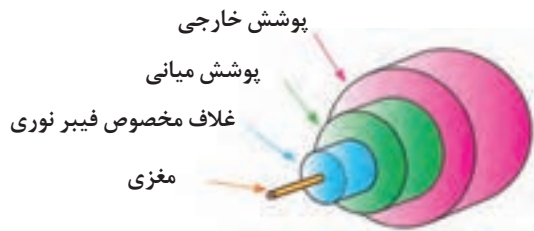
شکل ۴-۸- فیبر نوری و اجزای آن
