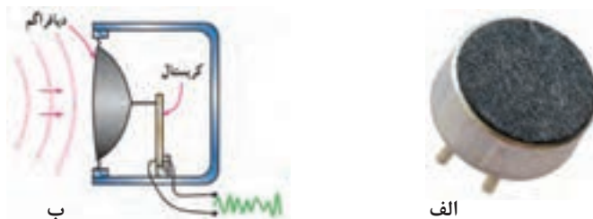
شکل ۱۶-۵- میکروفون کریستالی و ساختمان داخلی آن
