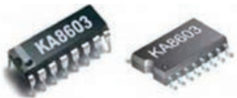
شکل ۵-۲۹- نمونه‌ای از آی‌سی پردازش صحبت
