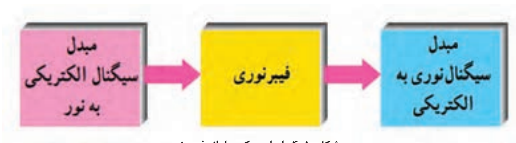
شکل ۴-۱۰- اساس یک سامانه فیبر نوری
