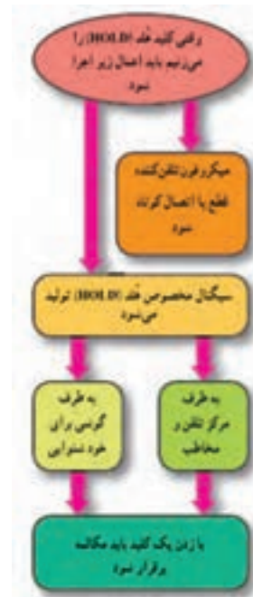
شکل ۳۲-۵- عملکرد مدار هلد
